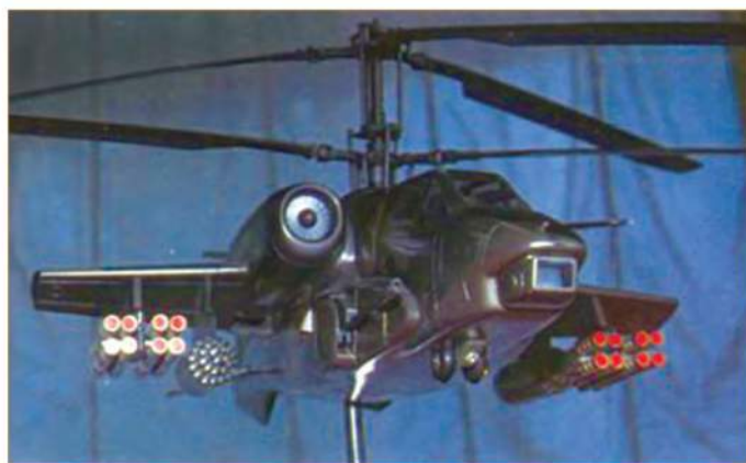
Модель одного из вариантов боевого вертолета В-80 с подвижной пушкой
