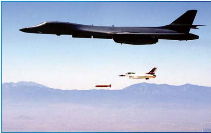
Испытательный сброс планирующей бомбы AGM-154 JSOW со спутниковым наведением с борта самолета B-1B «Лансер».
