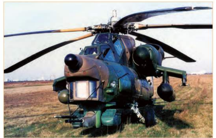
Ствол пушки Ми-28 борт 012 использовался в роли инструментальной штанги, на которой разместили ПВД и ДУАС
