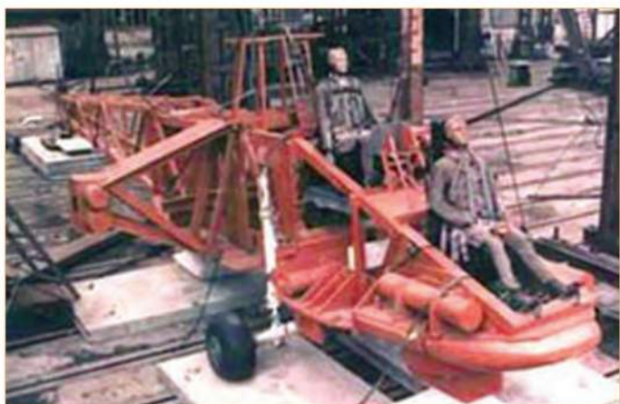
Стенд для отработки системы пассивной защиты вертолета Ми-28
