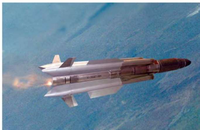
Модернизированная противокорабельная ракета X-31АД с активным радиолокационным самонаведением. Фото: http://namrium-rycu.livejournal.com
