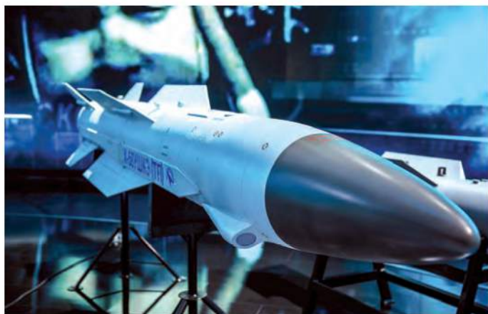
Тяжелая ракета X-58УШКЭ с противорадиолокационным и тепловым самонаведением, приспособленная для запуска из закрытых отсеков вооружения. Фото: Д. Дыдышко
