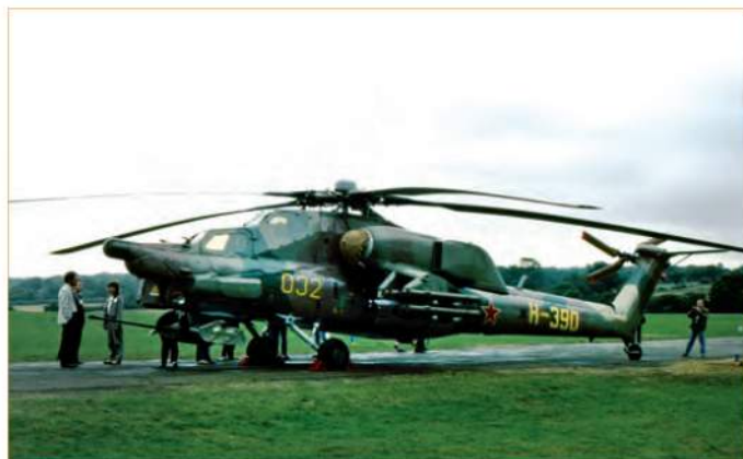
Третий опытный образец Ми-28 № 032 стал первым, на котором установили Х-образный рулевой винт и ЭВУ новой конструкции. Для экспонирования в Ле-Бурже, ему был присвоен выставочный номер «Н-390»
