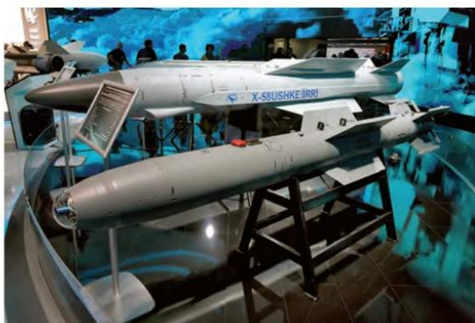
Корректируемая авиабомба КАБ-250С разработки КТРВ с комбинированной системой самонаведения — инерциальная платформа, приемник спутниковой навигации и оптическая ГСН. Фото: https://img-fotki.yandex.ru
