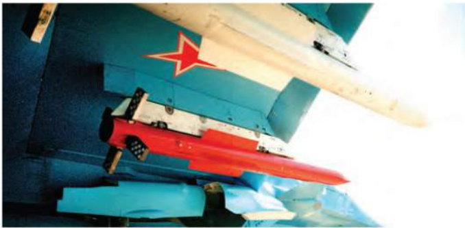
Серийная ракета средней дальности Р-77 («изд. 170») уже поставляется для всех современных самолетов ВВС России и испытывается в составе вооружения Т-50. Фото автора
