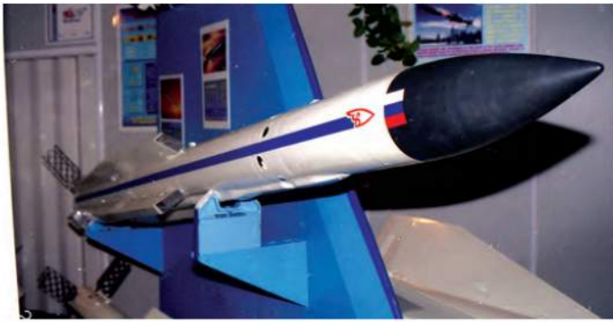
Опытная ракета повышенной дальности Р-77ПД («изд. 170ПД») с прямоточным двигателем — на ее основе для ПАК ФА проектируется ракета «изделие 180ПД». Фото: А. В. Карпенко // http://nevskii-bastion.ru
