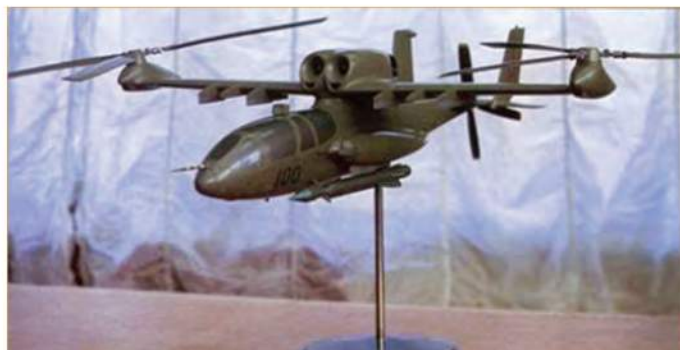
Демонстрационная модель двухместного боевого винтокрыла поперечной схемы В-100 с двумя трехлопастными, складывающимися НВ, одним толкающим винтом и ракетой класса «воздух-земля»
