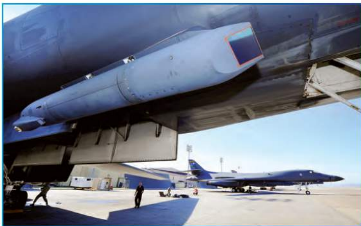
Контейнер AN/ALQ-33 «Снайпер» для обеспечения автономного применения оружия с оптической системой самонаведения на самолете В-1В. Фото: http://air-attack.com
