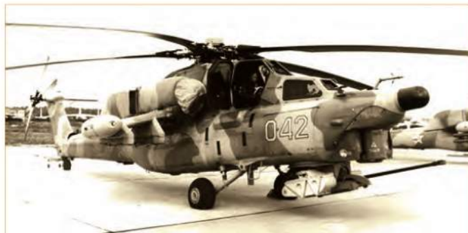
Ми-28 борт 042 с выставочным номером Н-315 и инструментальной штангой для ПВД и ДУАС, установленной на левом борту носовой части фюзеляжа. Фото: С. Г. Мороз
