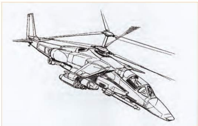
Первый вариант компоновки одноместного боевого вертолета, предложенный С. Н. Фоминым
