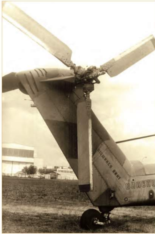
На опытный Ми-28 борт 012 был установлен трехлопастный рулевой винт от Ми-24.
