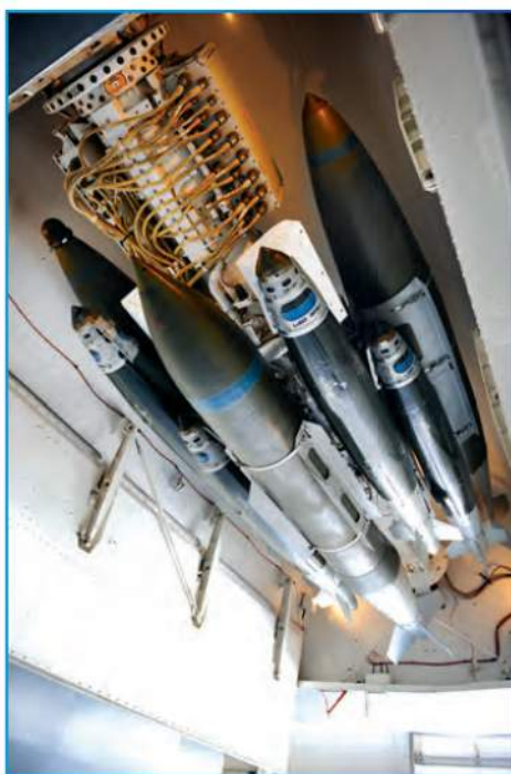
Бомбы JDAM четырех типов — GBU-31(V)3/B и GBU-31(V)1/B калибра 907 кг, GBU-32(V)1/B калибра 454 и GBU-38/B калибра 227 кг — на многозарядном держателе MER самолета B-1B, оснащенном СУО GATM Фото: http://www.acc.af.mil
