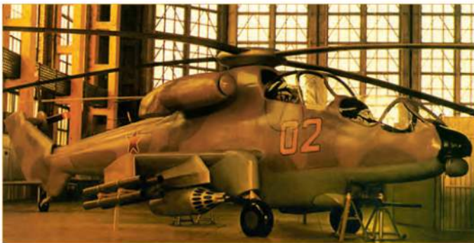
Один из шести полноразмерных макетов «изделия 280», в котором явно просматривается сходство с носовой частью Ми-24, а вот артиллерийская установка, как в проектах ААН США
