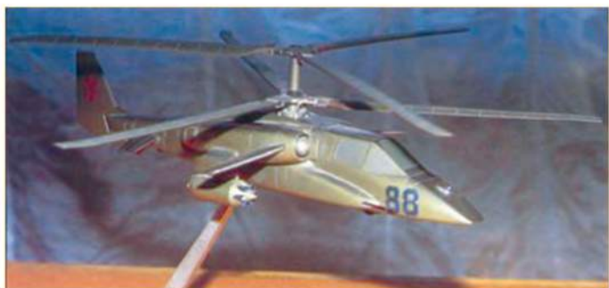
Модель первого варианта одноместного боевого вертолета ОКБ Н. И. Камова с самоустанавливающимся крылом и неподвижной пушкой
