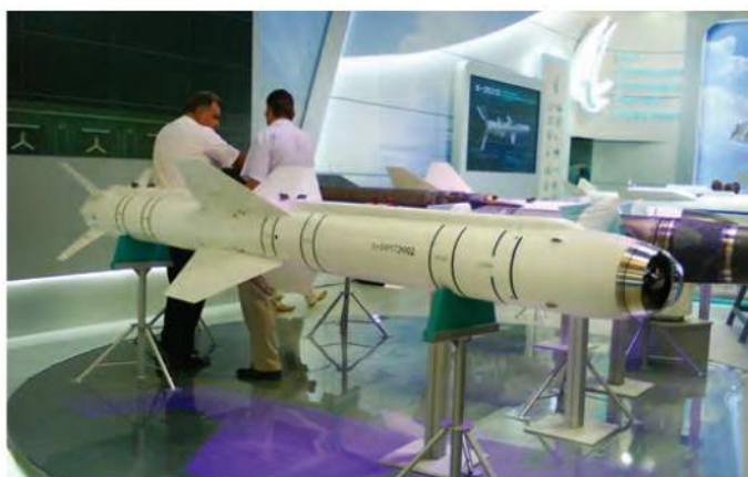
Ударное оружие самолетов 5-го поколения — малогабаритная модульная ракета X-38М (на фото — вариант X-38МЛ с лазерным полуактивным самонаведением). Фото: А. И. Кривобок
