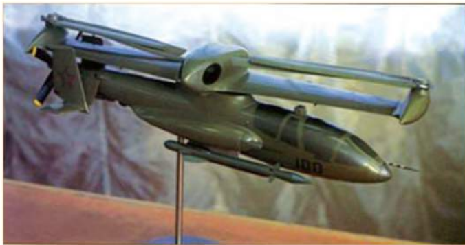
Модель В-100 со сложенными лопастями НВ и повернутым крылом
