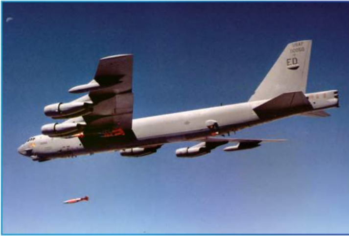
Самолет B-52H-160-BW выполняет испытательный сброс бомбы GBU-31(V)1/B JDAM. Он уже имеет усиленную внешнюю подвеску J-боеприпасов, что соответствует доработке Increment 1.2. Фото: http://fas.org
