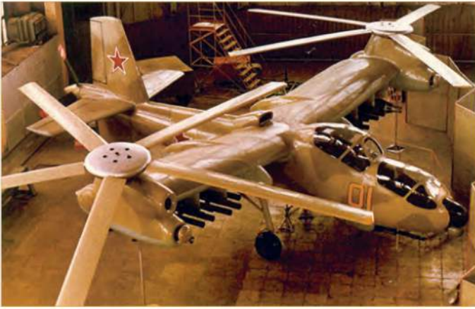
Макет двухвинтового вертолета МВЗ поперечной схемы с толкающим винтом
