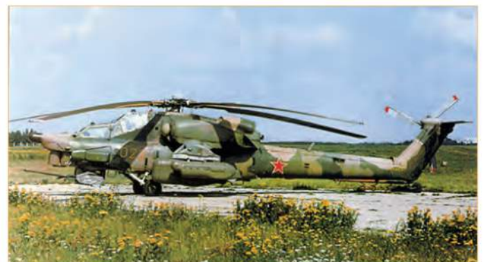
Второй опытный образец Ми-28 борт 022, предназначенный для испытания вооружения
