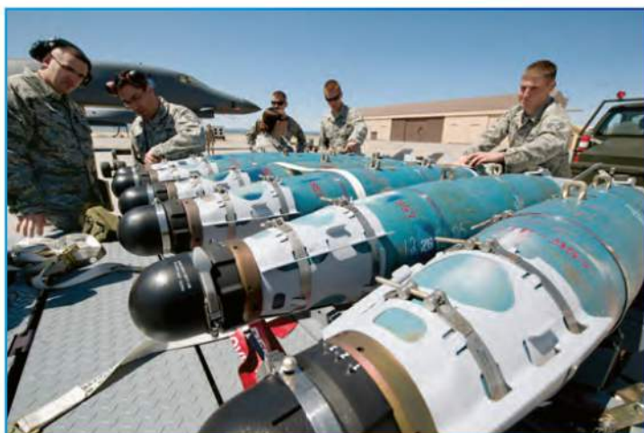
Проверка бомб GBU-54 LJDAM с комбинированной системой наведения (инерциальная платформа, приемник GPS и лазерная ГСН) перед подвеской на самолет B-1B — 12 мая 2012 г. Фото: http://www.deagel.com
