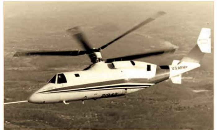
Экспериментальный вертолет S-69 (XH-59A) с жесткими соосными несущими винтами
