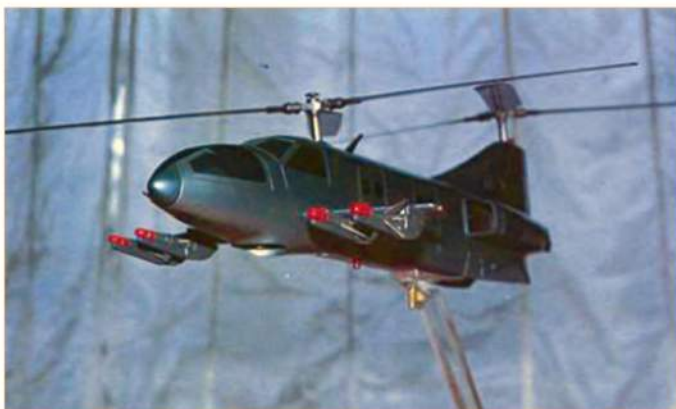
Демонстрационная модель вертолета ОКБ Н. И. Камова, свидетельствующая о проработках на фирме проектов продольной схемы
