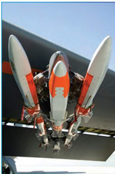
Подвеска малогабаритных ложных целей воздушного старта Ретейон ADM-160 MALD под крыло стратегического бомбардировщика В-52Н
