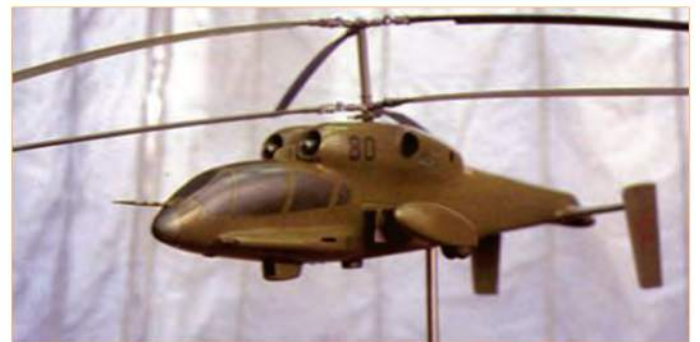
Модель первого варианта двухместного боевого вертолета ОКБ Н. И. Камова соосной схемы с неподвижной пушкой
