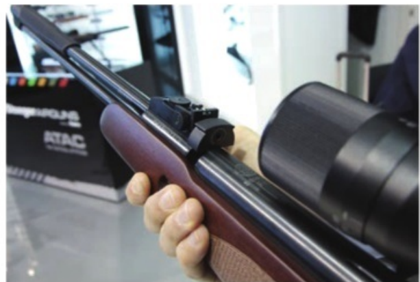
Пулеприёмник винтовки F40 поднимается достаточно высоко, чтобы стрелок легко мог вложить в него пулю
