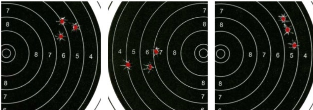
Типичные мишени чемпиона мира по пулевой стрельбе в упражнении «Бегущий кабан» Максима Степанова при стрельбе из охотничьего карабина Zastava MP22 патронами RWS (слева направо, масштаб 1:1): Target Rifle, Club и R50. Дистанция 50 м, сидя с упора, оптический прицел, поперечники 10 мм, 18 мм и 17 мм соответственно
