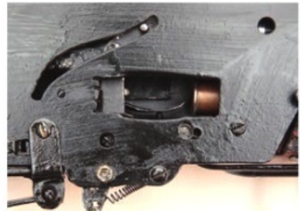
Затвор закрыт, досылающий рычаг поднят над затвором, патрон в магазине удерживается рычагом затвора
