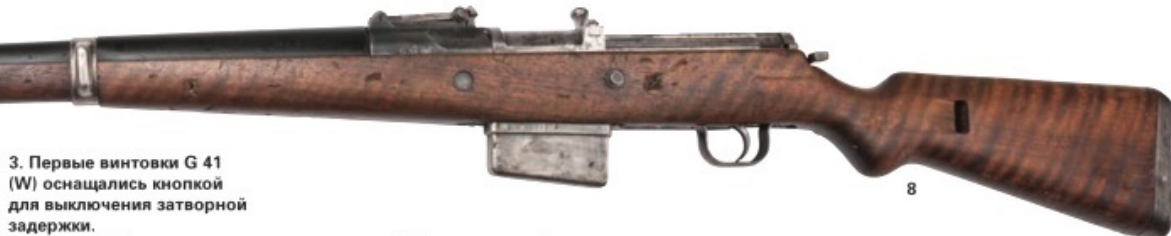
8. Заметна антабка на нижнем ложевом кольце и прорезь в прикладе для ремня карабина 98к.
