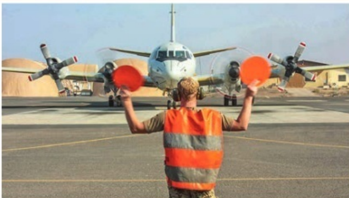
Уровень шума современных боевых самолетов на стоянке достигает величины 160 дБ. Поэтому работа аэродромного персонала немыслима без наушников. Особенностью наушников, используемых техниками, является то, что они не должны накапливать статическое электричество во избежание возгорания авиационного топлива. Фото © Bundeswehr/Piz EinFüKdo
