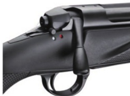
Затвор «Горизонта» оснащён массивным индикатором взведённого ударника, выступающим из хвостовика. Двухпозиционный предохранитель работает чётко, блокирует спусковой крючок и шептало
