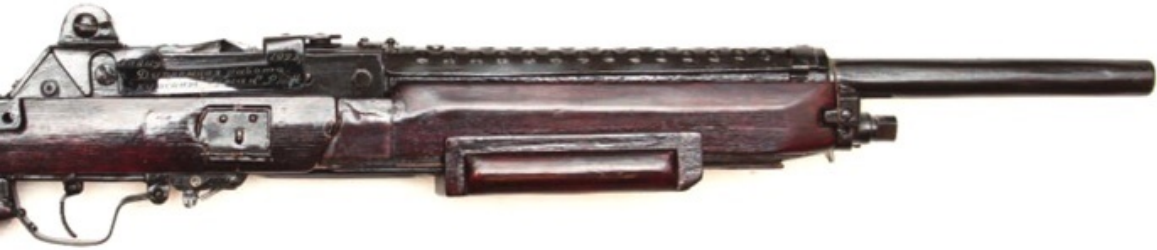
Общий вид макета 12,7-мм магазинной винтовки (дипломный проект Р. Н. Чумака, ПВАИУ, 1992–1993 гг.)
