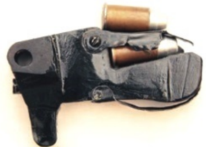
Затвор с муляжами патронов: один лежит на приёмном лотке затвора, второй находится на крышке приёмного лотка
