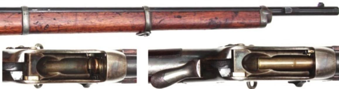
Запирающий механизм винтовки Кraag-Петерсена. Затвор опущен на линию подачи
