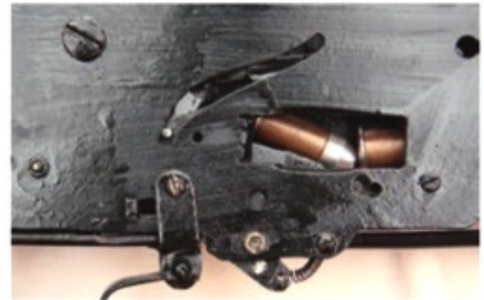
Вид на окно для заряжания магазина. Патрон подан на приёмный лоток затвора и поджимается патроном, выходящим из магазина
