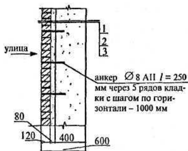
Рис. 3. Стена из пенобетонных блоков (для жилых помещений):
