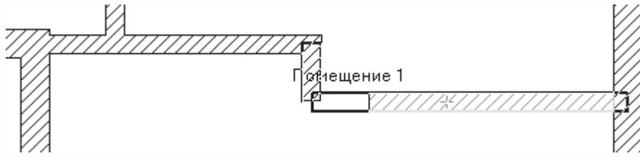
Рис. 3.61. Совместное выравнивание двух стен
