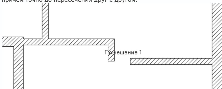
Рис. 3.60. Нестыковка угловых стен
