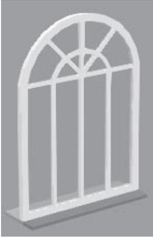
Рис. 2.41. Окно расширенной конструкции после добавления тангенциальных и радиальных перемычек в его верхнюю часть
