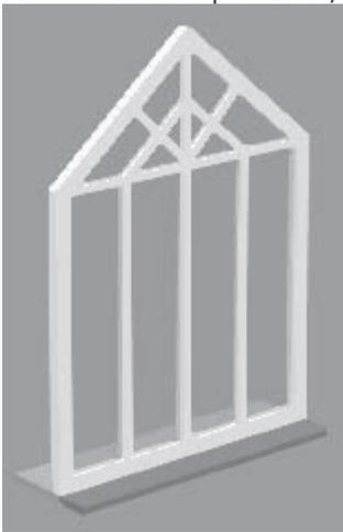
Рис. 2.42. Окно с тангенциальными и радиальными перемычками и с треугольной форточкой
