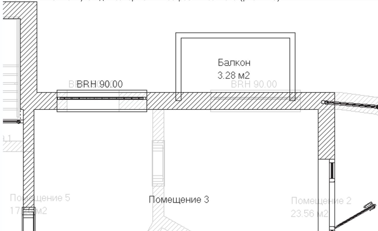
Рис. 4.28. Изображение балкона на чертеже
