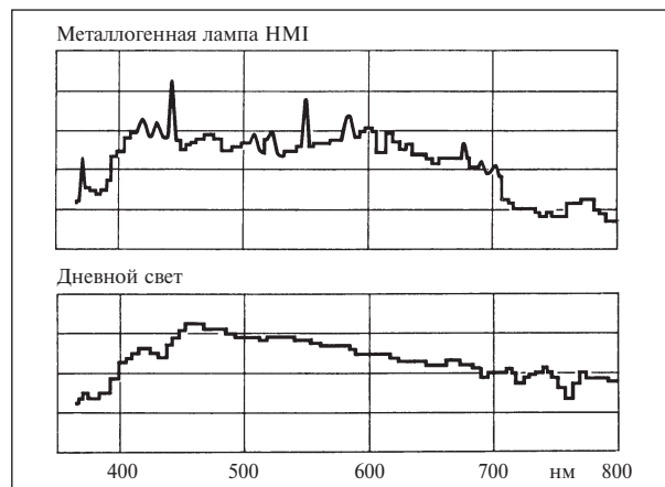
Спектр металлогенной лампы в сравнении со спектром дневного света
