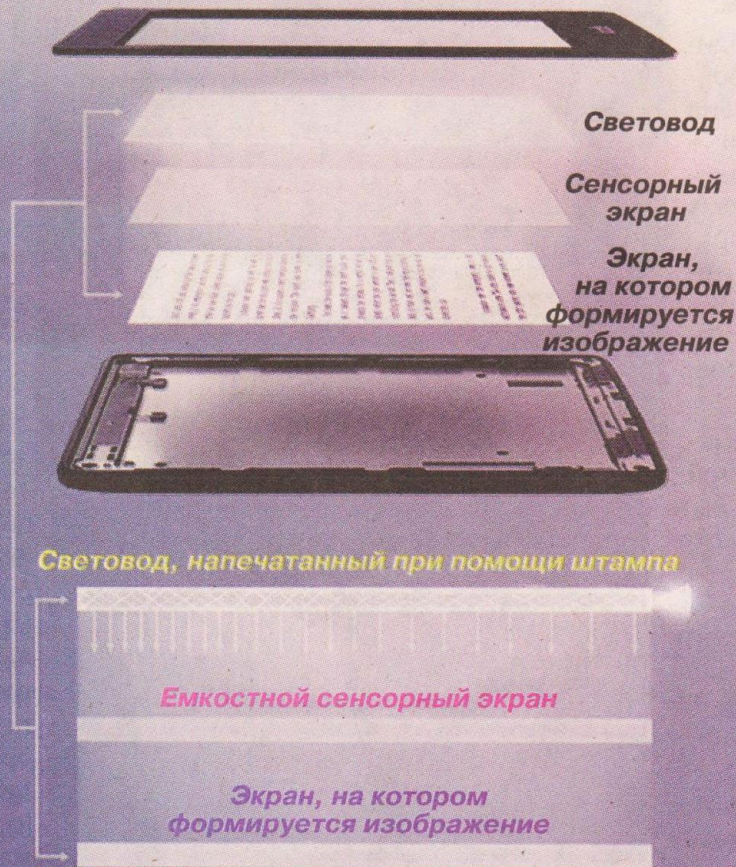
Рис. 16. Экран Kindle PaperWhite. Нижний слой – обычный E-Ink Pearl, далее идет емкостный сенсорный экран, поддерживающий два касания, верхний – особый отражающий слой (световод). В нижней части экрана находятся четыре светодиода, спрятанные за лицевой панелью. Свет от них поступает внутрь верхнего слоя, где отражается вниз, освещая создающий изображение экран, от него мы получаем отраженный свет, который попадает на глаз читателя.
