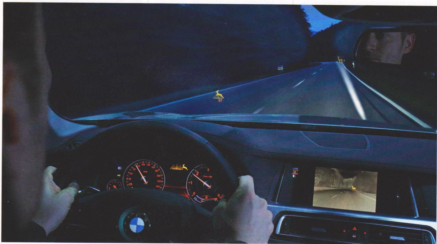
■ Так на ночной дороге выглядит животное, подсвеченное узким лучом дальнего света. Яркий мерцающий луч не только оповещает водителя об опасности, но и делает сам автомобиль хорошо заметным.
