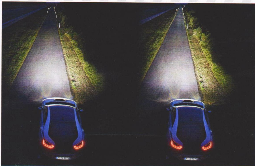
■ Фото демонстрирует преимущество лазерного дальнего света (справа) перед светодиодным (слева). В свете лазерных фар становятся хорошо заметны объекты на расстоянии 600 м от машины, тогда как предел возможности LED-фар – 300 м. При движении днем водитель может видеть предметы на расстоянии до 2 км.
