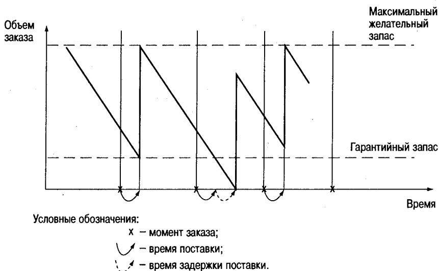
Рис. 43. ГРАФИК ДВИЖЕНИЯ ЗАПАСОВ В СИСТЕМЕ УПРАВЛЕНИЯ ЗАПАСАМИ С ФИКСИРОВАННЫМ ИНТЕРВАЛОМ ВРЕМЕНИ МЕЖДУ ЗАКАЗАМИ
