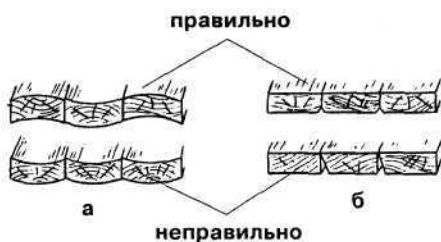
Рис. 15. Порядок укладки и сплачивания досок при настилке «чистого» пола: а — укладка; б — сплачивание
