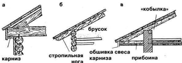
Рис. 22. Разные варианты устройства карниза: а, б — карниз по затяжке; в — карниз по прибоинам
