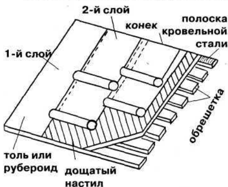
Рис. 27. Порядок укладки рулонных материалов. Перпендикулярный способ покрытия
