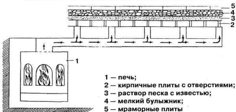
Рис. 7. Устройство пола в римско-ирландской бане
