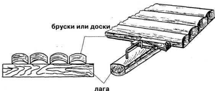
Рис. 16. Укладка брусков и досок выпуклой стороной вверх
