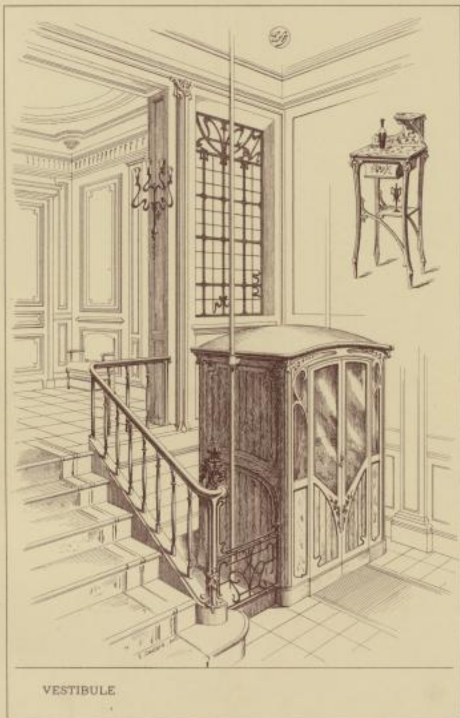
CABINE D'ASCENSEUR EN BOIS D'ACAJOU ET PARTIES CUIVRES. RAMPE EN FER FONDUE ET ALAQUÉ. PETITE TABLE FANTAISIE EN BOIS DE STYRONNE.
