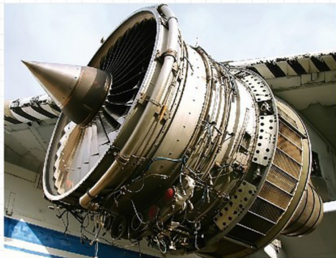
▲ Турбореактивный двухконтурный двигатель Д18Т предназначен для установки на сверхтяжелые транспортные самолеты Ан-124 «Руслан» и Ан-225 «Мрия» Фото: Igor Babin, www.jetphotos.com
