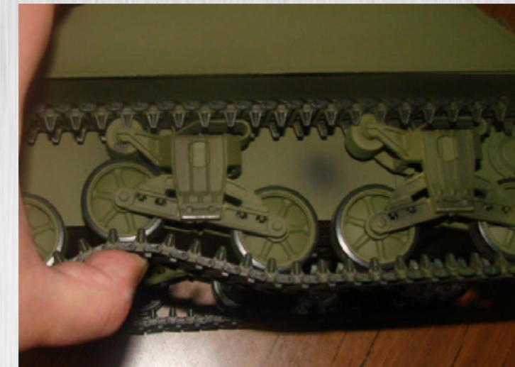
Каждое опорное колесо имеет собственную подпружиненную подвеску – неровности гусеницы просто проглатывают
