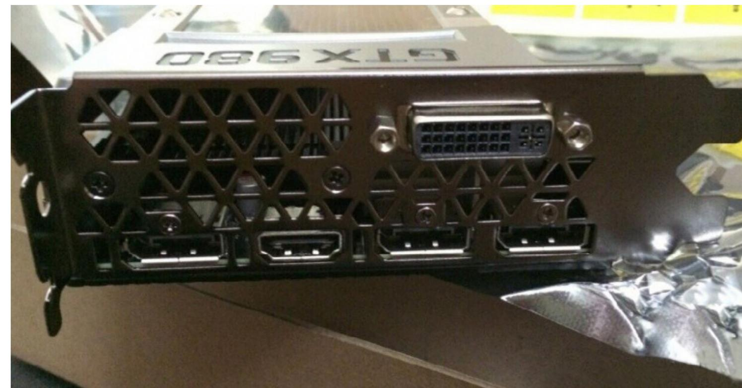
рования TMU, 64 блока растеризации ROP, 256-битная шина памяти GDDR5, 4 Гбайт видеопамати. Основные тактовые частоты ядра – 1126 и 1216 МГц при разгоне GPU Boost, частота памяти – 7012 МГц. Жрать будет 165 Вт.
