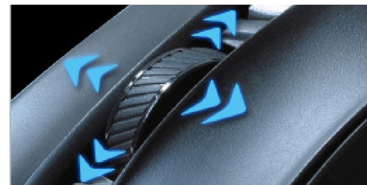
Дизайн эргономичный, батарея подзарядается по интерфейсу microUSB, колесико меняет функции в зависимости от отклонения оси вращения, есть две программируемые кнопки на боковой грани. И еще есть кнопка подстройки разрешения сенсора на лету. В общем, вещь, походу, особенно актуальная для ноутбуков, ведь, блин, пока найдешь, где мышь пристроить... Подробности тут: [goo.gl/z5BLdI](http://goo.gl/z5BLdI).
