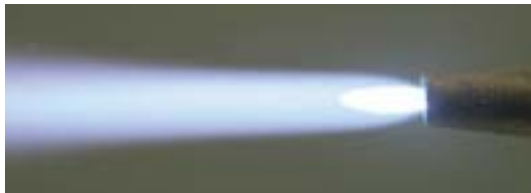
Факел пламени горелки, насыщенный кислородом (бледно-голубого цвета и маленький)
