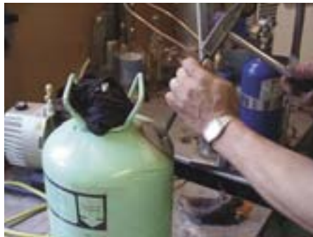
Только керном. Сверлить нельзя, иначе попадет стружка
