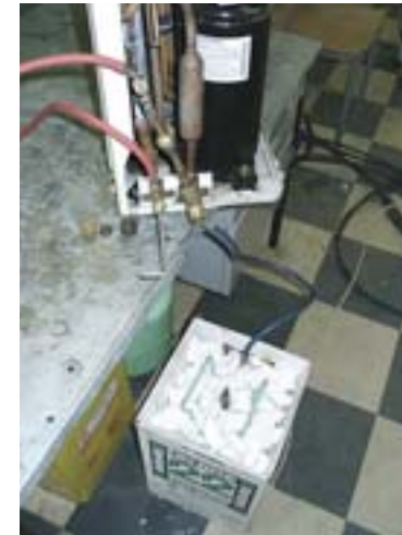
Эвакуация хладагента с помощью отвакуумированного баллона
