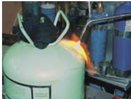
Нагрев места, где будет сделано отверстие
