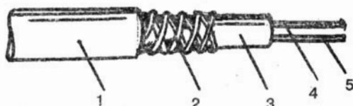
Рис. 80. Нагревательный кабель марки ЕСО: 1 - оболочка из ПВХ-пластика; 2 - оплетка из медной проволоки; 3 - термостойкий ПВХ-пластик; 4 - вспомогательная жила из отожженной меди; 5 - нагревательная жила
