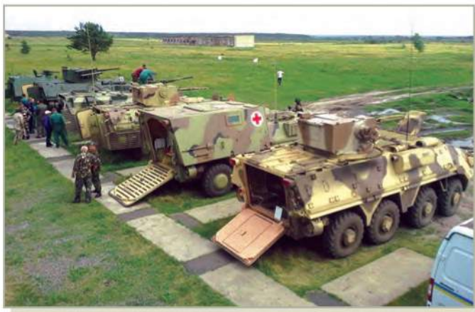
На переднем плане БТР-4МВ. Хорошо видна откинутая аппарель для высадки десанта. За ним — медицинский БСЭМ-4К, также с откинутой аппарелью.
