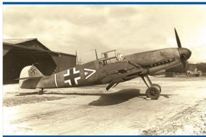
Новый Bf 109F-2 с 1200-сильным мотором DB 601N и облегченным вооружением появился на фронте в 1941 году. Фото: http://old.messerschmitt-bf109.de
