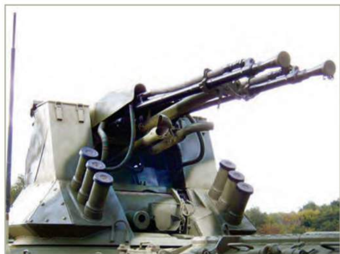
Боевой модуль БАУ-23-2, вооруженный спаренной 23-мм артиллерийской установкой.
