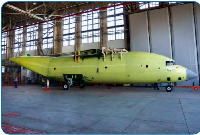
Завершение стапельной сборки фюзеляжа первого экземпляра среднего транспортного самолета Ан-178 29 июля 2014 года. За необыкновенно чистые аэродинамические формы и характерный фюзеляж, плавно переходящий в изящную носовую часть, споттеры окрестили самолет «дельфином».
