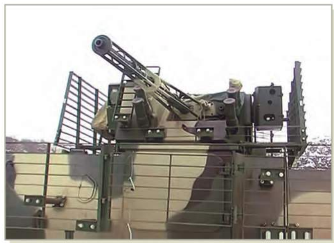
На последних выпусках БТР-4 решетчатые противокумулятивные экраны установлены не только на корпусе, но и на башне.
