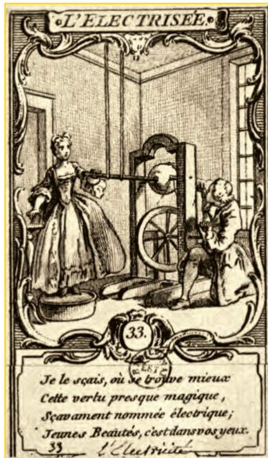
Электростатическая машина с шаровым натираемым телом.
