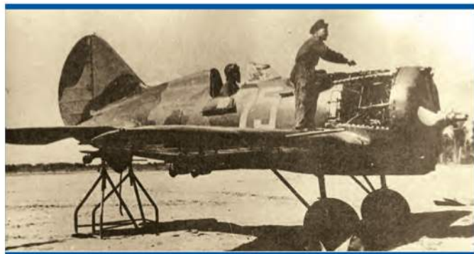
Накануне войны И-16 составляли значительную часть нашей истребительной авиации. На фото — пристрелка вооружения на типе 29 — последней модификации «ишачка». Фото: http://tsushima.su
