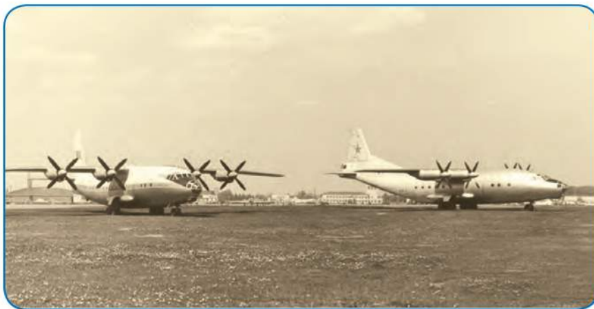
В одном строю пассажирский Ан-10 и военно-транспортный самолет Ан-12, созданные по принципу унификации.
