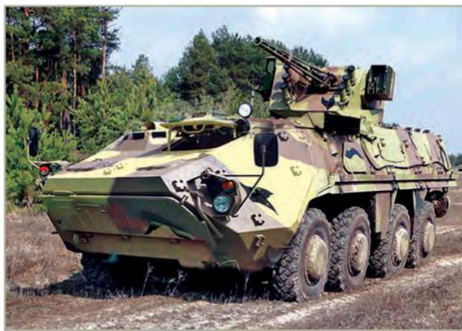
БТР-4МВ обладает пятым уровнем защиты, т. е. способен выдержать обстрел снарядами калибра 25 мм с расстояния около 500 м.
