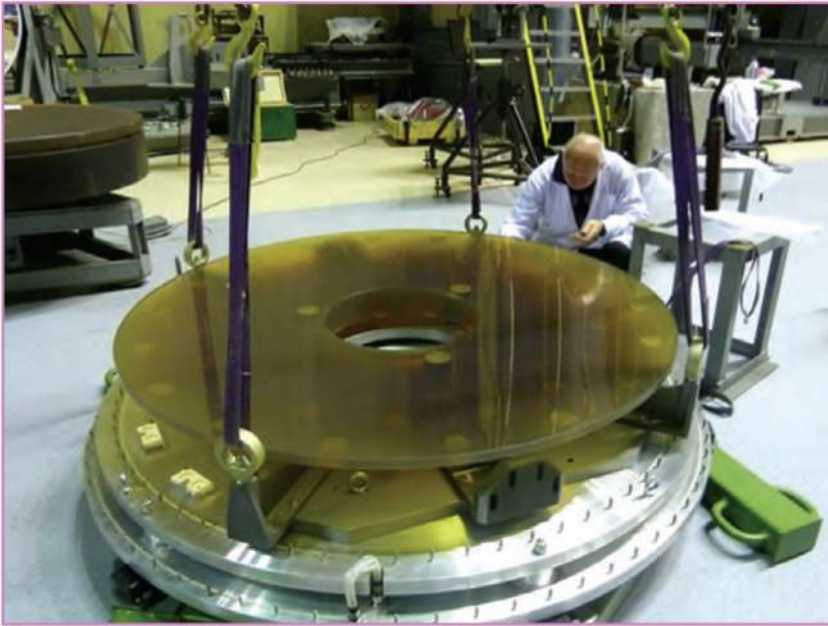
Главное зеркало телескопа T-170M
