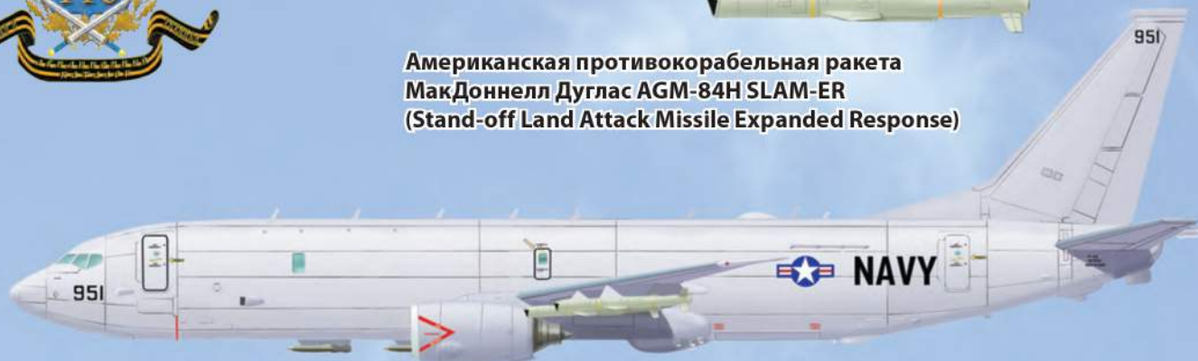
Морской многоцелевой патрульный и ударный самолет Боинг Р-8А «Посейдон» из эскадрильи VP-4 авиации ВМС США — авиабаза Канехэ Бей, Гавайи, весна 2015 г. Самолет вооружен ракетами «воздух-поверхность» AGM-84H SLAM ER и авиабомбами Mk. 82 «Снейкай»
