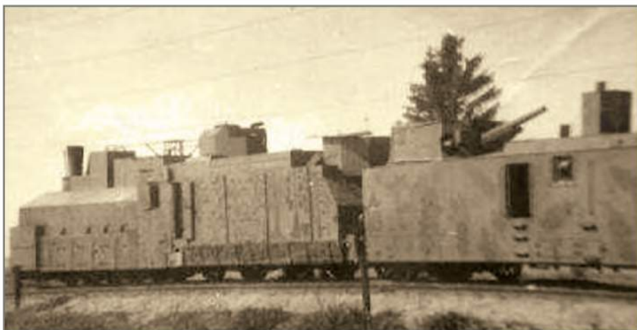
Тяжелый бронепоезд — впереди бронепаровоз ПР-35, за ним тяжелая бронеплощадка ПТ-35
