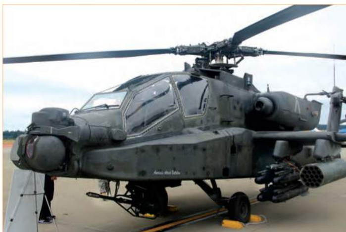
Модификация AH-64D «Апач Лонгбоу» без наддулочной РЛС
