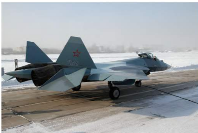
Система управления истребителя ПАК ФА включает отклоняемый наплыв, предкрылки, флапероны, элероны, цельноповоротные кили и стабилизаторы, а также сопла двигателей, отклоняемые всеракурсно.
