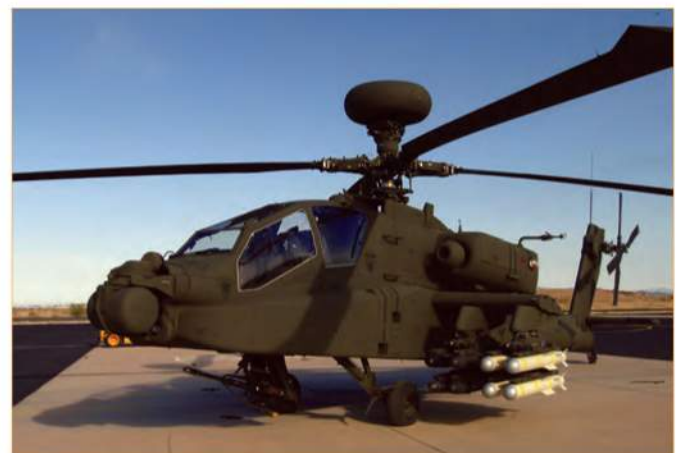
Модификация AH-64E «Апач Лонгбоу» с комплектом управляемых ракет JAGM (Joint Air-to-Ground Missile) на внешнем пилоне
