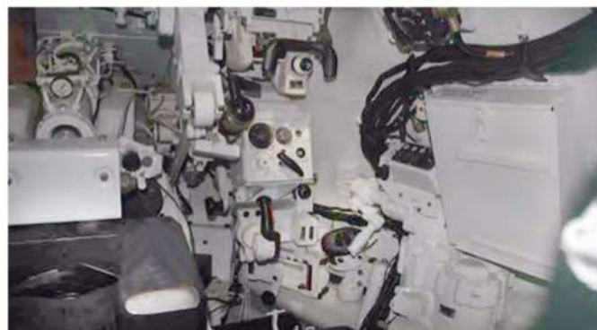
Место наводчика в танке M103A2
