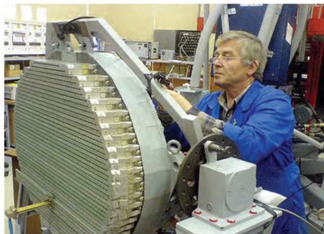
Носовая активная фазированная решетка Н036-01-1 Х-диапазона бортового радиолокационного комплекса истребителя Т-50 имеет ширину 900 мм, высоту 700 мм и состоит из 1 522 твердотельных приемопередающих модулей.
