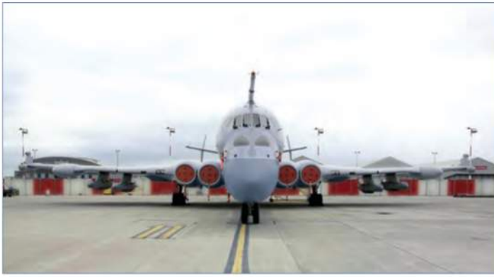
Опытный морской стратегический разведывательно-ударный самолет «Нимрод» MR.4 — под крылом подвешены четыре крылатые ракеты «Сторм Шэдоу»
