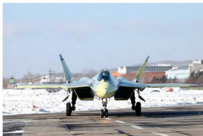
Шестигранная форма носовой части Т-50 выбрана из учета оптимального формирования и обтекания самолета и его ЭПР. Фото: http://www.paralay.com/pakfa
