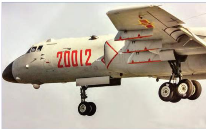
Вид крупным планом на новую носовую часть, увеличенные гондолы двухконтурных двигателей WS-18 и пилоны для подвески вооружения самолета Сиань Н-6К Самолет Н-6К СЯС КНР с шестью подкрыльными узлами
