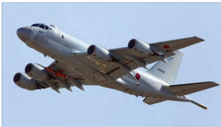
Базовый патрульный самолет Kawasaki XP-1 с противокорабельными ракетами AMS-1 под правым крылом и AGM-84A «Гарпун» под левым
