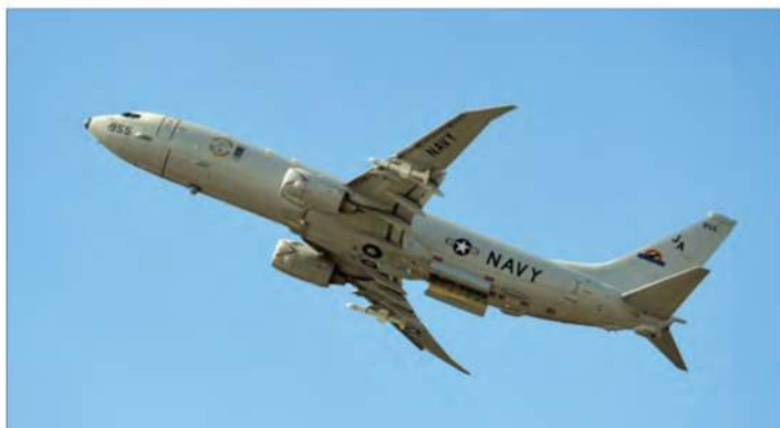
Американский базовый патрульный самолет дальнего действия Боинг Р-8А «Посейдон» с крылатыми ракетами AGM-84E SLAM
