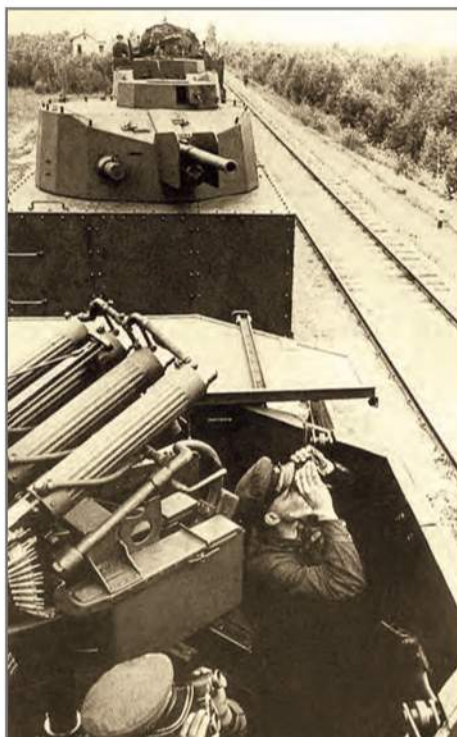
Платформа СПУ-БЕПО, вооруженная стандартной счетверенной зенитной установкой пулеметов «максим». Крыша открыта, на снимке вверху хорошо видна сдвинутая створка
