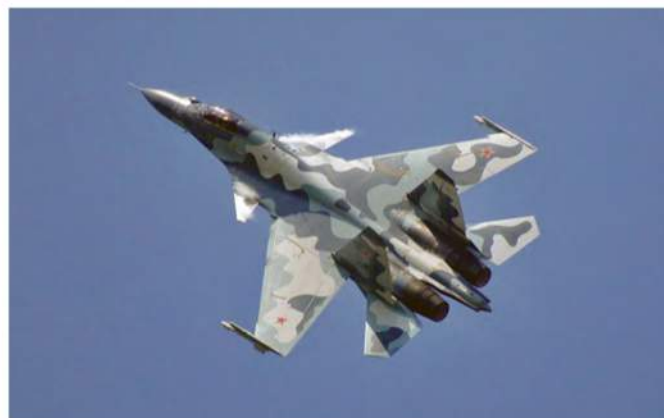
Продольный интегральный триплан с передним горизонтальным оперением Т-10М (Су-37) — первый шаг фирмы «Сухой» к сверхманевренности. Фото: http://ammonation.ru
