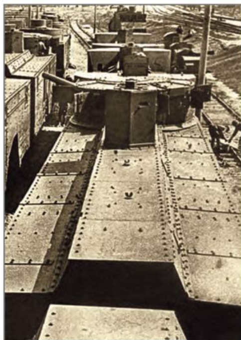
Тяжелый бронепоезд. Хорошо виден короб на крыше бронеплощадки и шестигранная командирская башенка со смотровыми щелями
