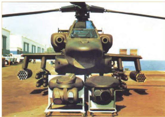
Массово-габаритные макеты оптико-электронных обзорно-прицельных систем фирм «Мартин-Мариэтта» (слева) и «Нортроп» на фоне «Апача»
