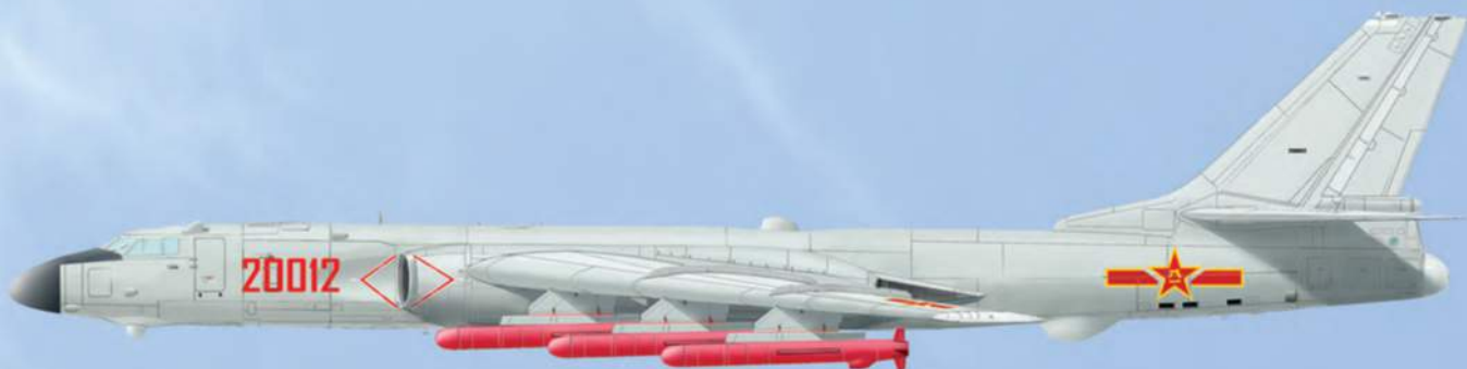
Ракетоносец и бомбардировщик Сиань Н-6К Стратегических ядерных сил Китая с дозвуковыми крылатыми ракетами большой дальности CJ-10 (ракеты имеют автокорреляционную систему самонаведения по рельефу местности и ядерную БЧ)
