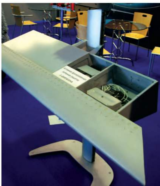
Установка в предкрылке самолета Т-50 длинноволновой АФАР Н036Л L-диапазона, предназначенной для обнаружения малозаметных целей и обеспечения работы системы распознавания «свой-чужой».
