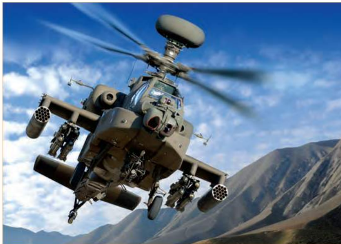
Модификация AH-64D «Апач Лонгбоу» с наддулочной РЛС AN/APG-78, двумя блоками для 70-мм НАР и четырьмя УР «Хеллфайр»
