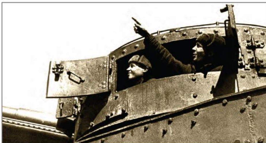
Башня тяжелой бронеплощадки раннего выпуска, для облегчения наблюдения и обеспечения вентиляции в ее бортах были сделаны двустворчатые окна
