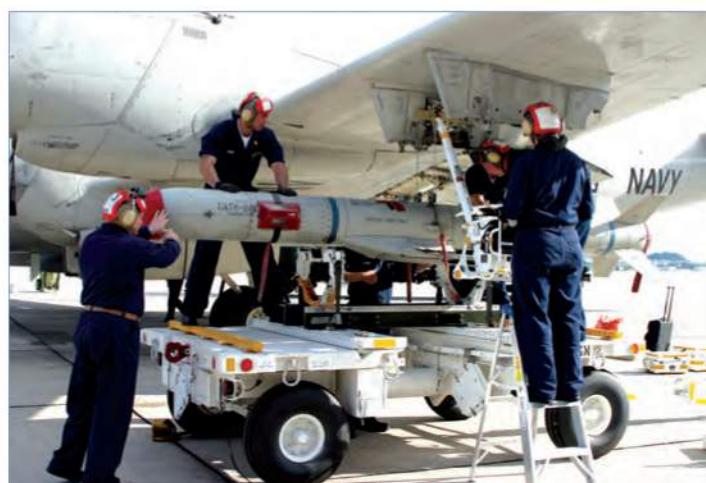
Подвеска на самолет P-3C «Орион» ВМС США учебной ракеты CATM-84K, которая заменяет на учениях боевые AGM-84H/K SLAM-ER
