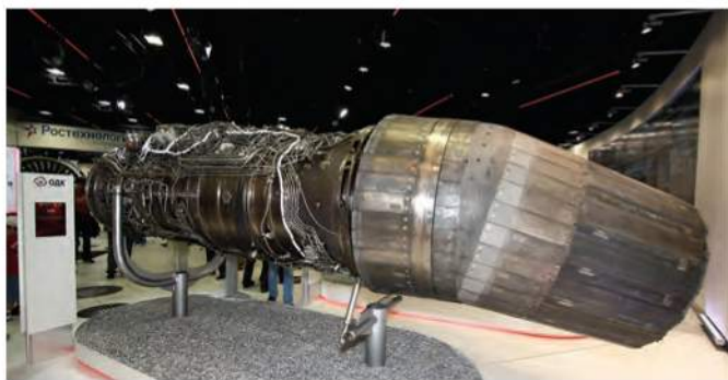
Двигатель АЛ-41Ф1 (изд. 117) с всеракурсно управляемым вектором тяги используется на истребителе 5-го поколения ПАК ФА только на первом этапе его разработки.
