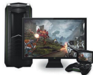
В консольном режиме изображение, выводимое игрой, можно пересылать с ПК на телевизор, используя в качестве передаточного звена Shield, но в случае применения контроллера Bluetooth задержки могут оказаться весьма значительными
