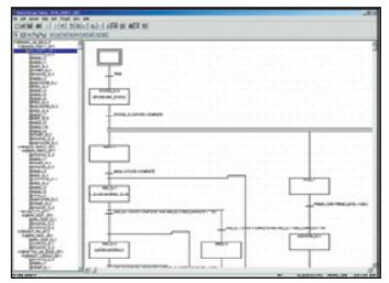
Настройки, устанавливаемые вами в редакторе Recipe Editor, взаимодействуют с конфигурациями оборудования, которые вы создали в редакторе Equipment Editor. Например, модуль оборудования управляет температурой в реакторе, но соответствующая температурная уставка определяется рецептом. Такая взаимосвязь позволяет использовать рецепты для изготовления нескольких продуктов с одной и той же логикой оборудования, без необходимости жесткого программирования параметров для каждого продукта.
