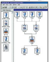
интерфейсом редактора Equipment Editor, вы используете шаблоны для создания и поддержания информации о вашем технологическом оборудовании. После создания физической модели содержащаяся в ней информация станет доступной для всех остальных компонентов системы RSBizWare Batch.
