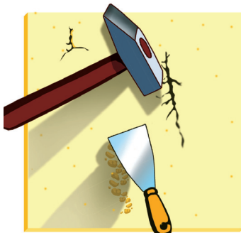
Рис. 3. Визначення міцності поверхневого шару конструкції
