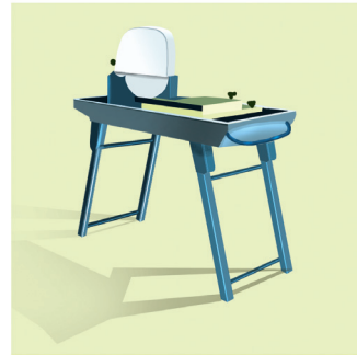
Рис. 10. Електричний верстат з верхнім розміщенням алмазного диска фірма Diamant Boart (Бельгія)
