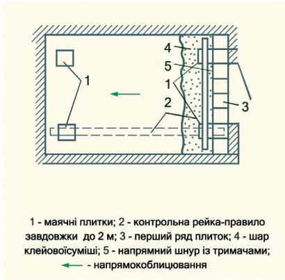
Рис. 21. Облицювання прямокутної підлоги площею до 4 м 2 :
