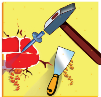
Рис. 4. Усушення відшарувань за допомогою скарпеля
