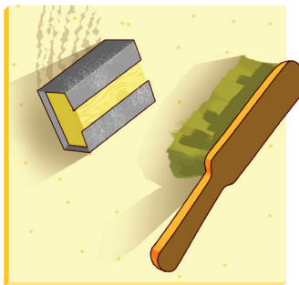
Рис. 2. Обробка лакофарбового покриття за допомогою наждакового паперу і металевої щітки
