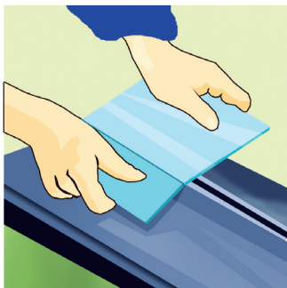
Рис. 7.а,б. Розламування надрізаної плитки об кромку повзуна плиткоріза (а) та відколювання вузької смуги плитки гострозубцями (б)
