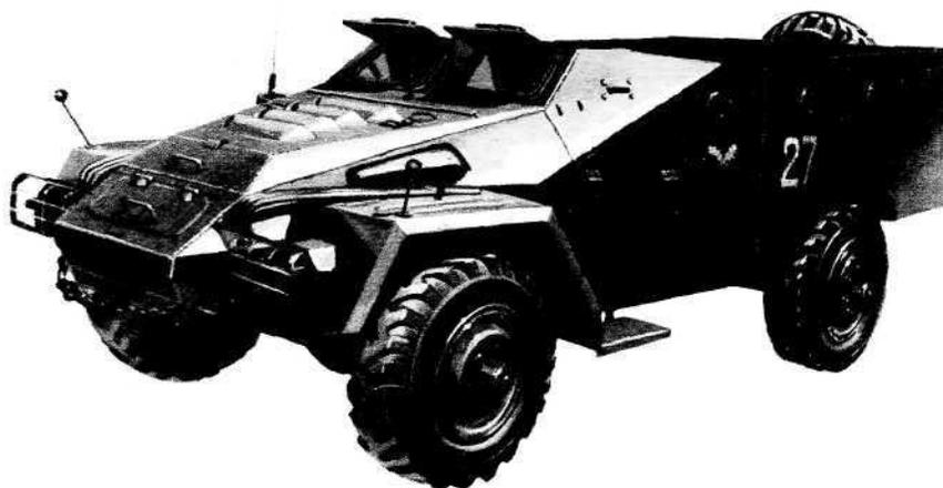
БТР-40 на базе узлов ГАЗ-63. 1950 г.
