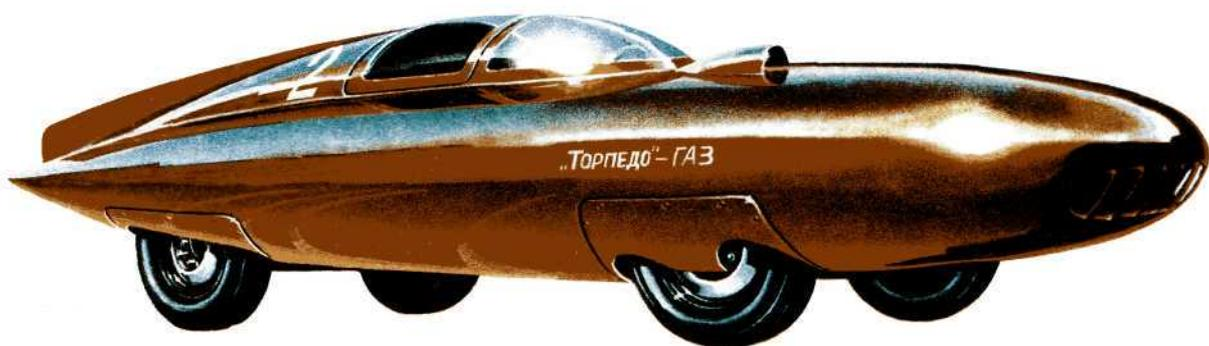
Гоночный автомобиль «ГАЗ-Торпедо» с дюралюминиевым несущим кузовом. 1951 г.
