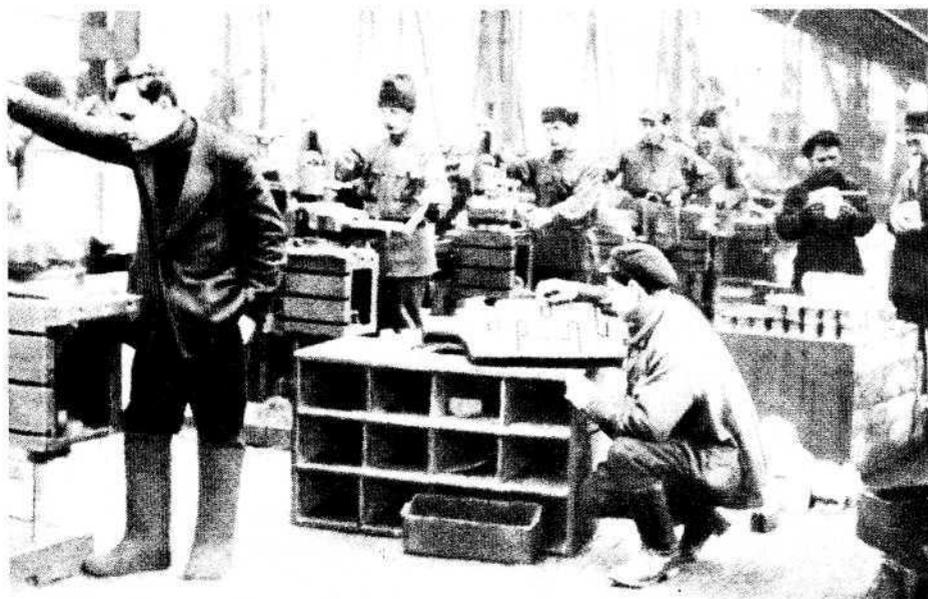
Изготовление деталей для первых десяти АМО-Ф-15. Заготовку колеччатого вала высверливали по контуру разметки из стальной плиты. Октябрь 1924 г.
