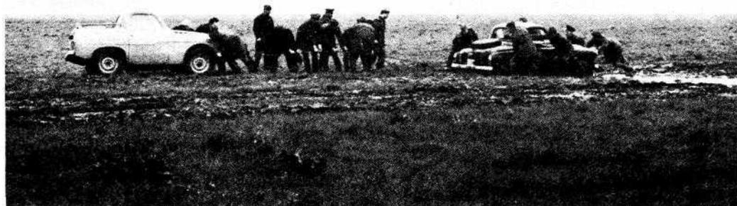
Испытания опытных образцов ГАЗ-73: слева — модификация с кузовом «пикап», справа — «купе». 1955 г.
