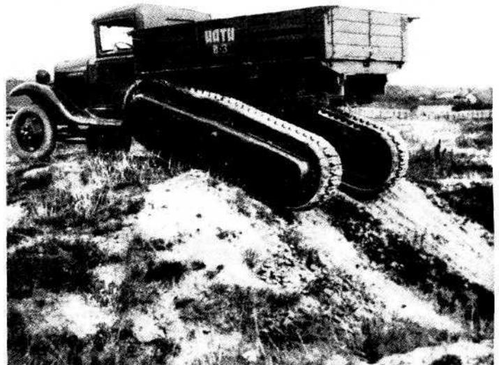
Испытания машины НАТИ-ВЗ, прототипа ГАЗ-60. 1936 г.
