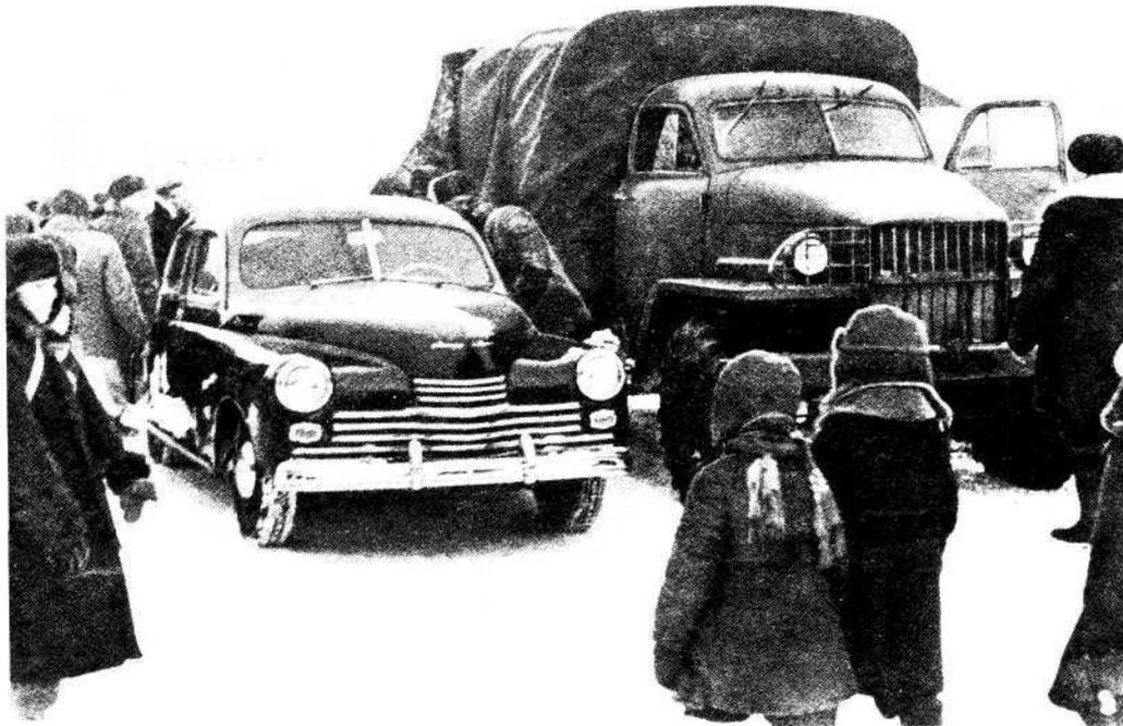
Опытный образец ГАЗ-20 рядом с экспериментальным ГАЗ-63. 1945 г.
