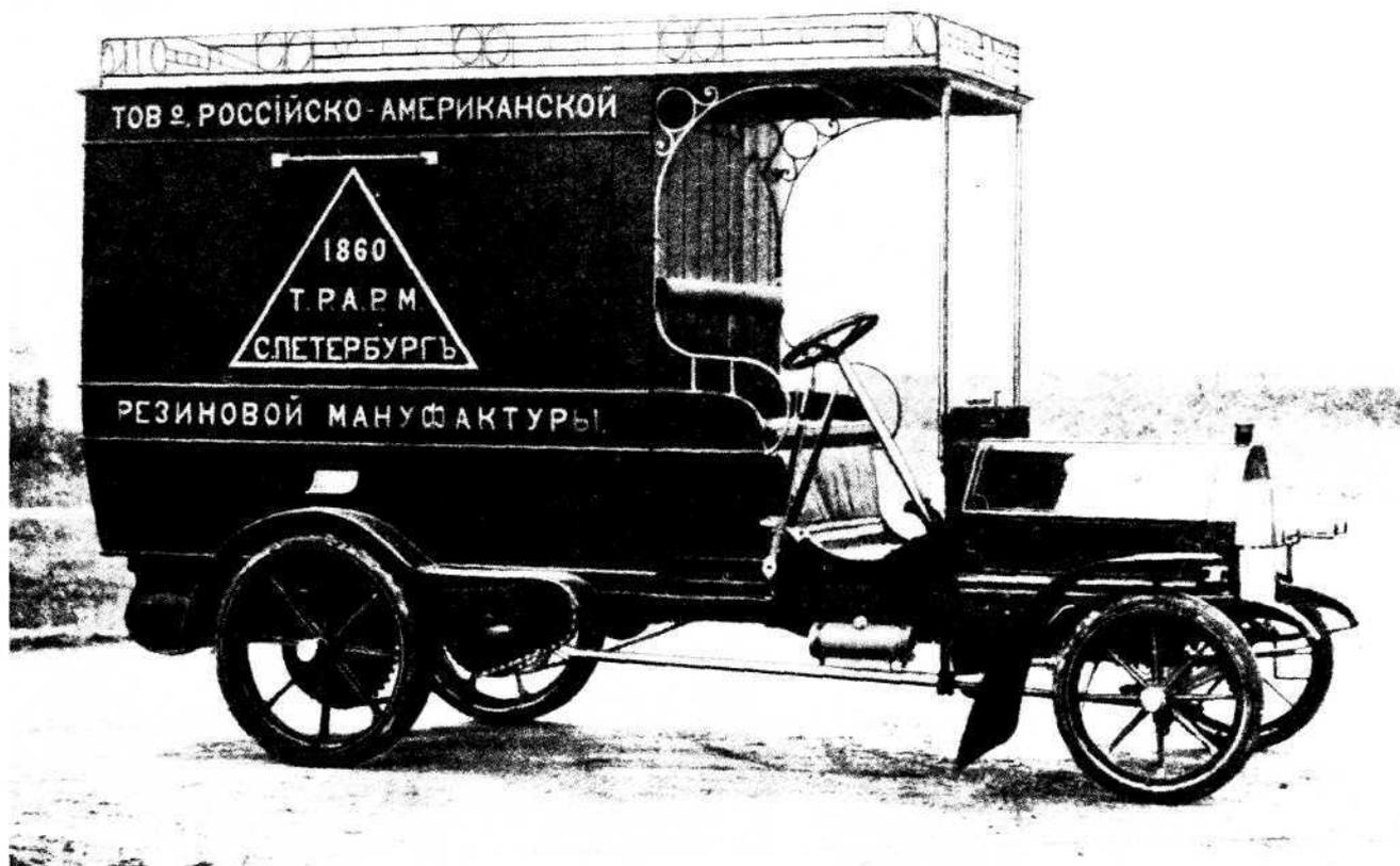
Фургон «Лесснер» грузоподъемностью 1200 кг. 1907 г.
