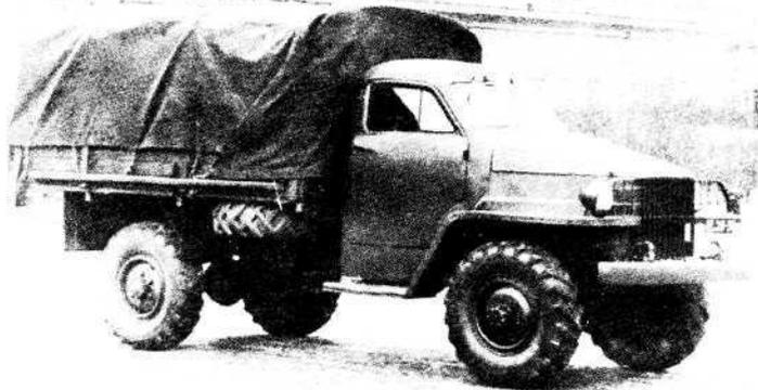
Опытный образец ГАЗ-63 с кабиной и оперением от «Студебеккера». 1946 г.
