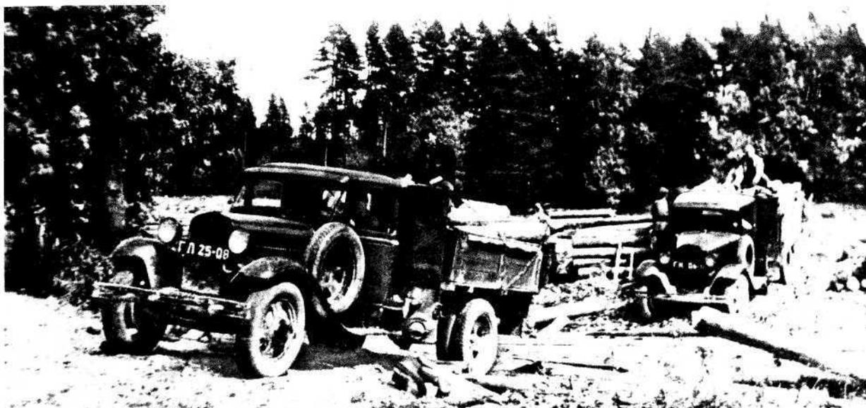
Машины ГАЗ-42 на вывозке древесины из леспромхоза.
