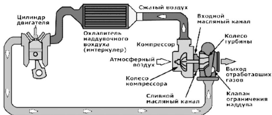
Рис. 2.1. Схема системы турбонаддува с промежуточным охладителем
