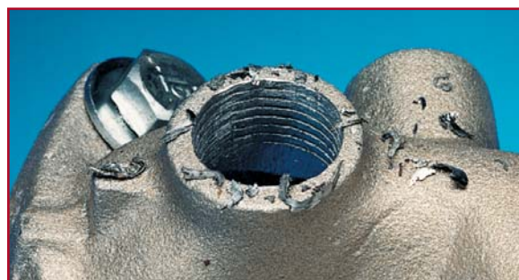
Сорванная резьба до ремонта
