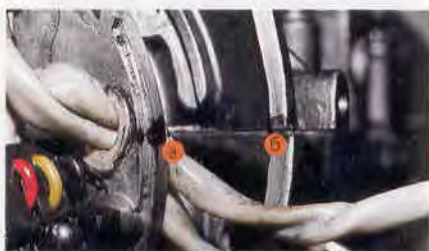
Фото 3. Блок управления зажиганием и генератор: 1 – статорная пластина; 2 – катушка освещения; 3 – обмотка зажигания.
