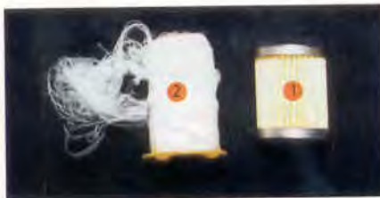
Фото 9. Наиболее распространенный способ фильтрации – гофрированная «шторка» (1), выполнена из специальной бумаги с высокой очищающей способностью. Такая конструкция традиционна для большинства производителей фильтров. Новый способ очистки топлива, получивший название объемной фильтрации: внутренности Spectrol Ultra похожи на шпатель, обмотанную несколькими слоями ниток (2).
