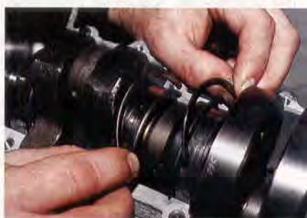
Фото 8. Ведущий шкив и центробежный регулятор: 1 – центральный болт; 2 – корпус регулятора; 4 – пружина; 5 – грузики с осями; 6 – ведущий вал с резьбовыми отверстиями под съемник.
