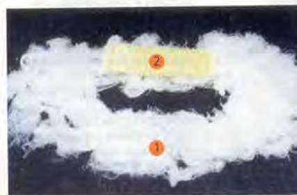
Фото 10. Развернутые в длину «перегородки» фильтрующего элемента Spectrol Ultra 1 превышают площадь бумажного гофра 2 в несколько раз. Поэтому и грязеемкость его значительно большая, чем у фильтровальных «бумажек».
