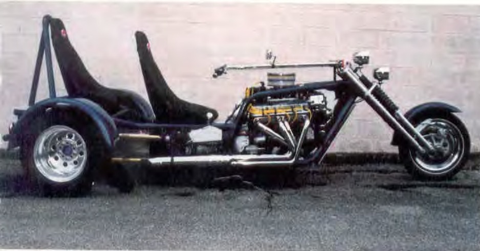
«Lightning» с двигателем «Chevrolet ZZ4» (5,7 л, 355 л.с.).
