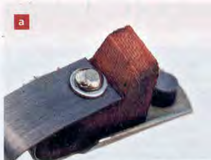
У текстолитовых упоров обязательно проверьте нажимную площадку: а – ровно обработанная деталь обеспечит стабильность зазора; б – брак (перекос), допущенный при обработке, приведет к быстрому износу площадки, зазор уменьшится и двигатель будет работать нестабильно.
