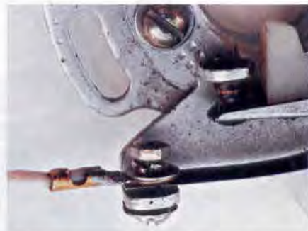
Место расположения дополнительной пружинной шайбы на клеммном болте прерывателя «Иж».
