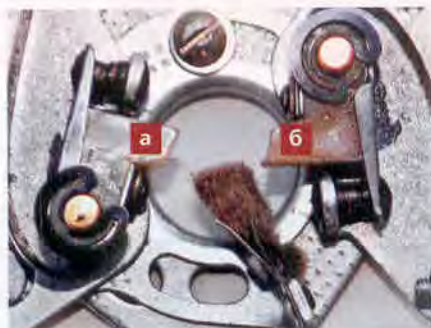
Выбирайте светлые капроновые упоры (а) – они более износостойкие, чем темные (б).
