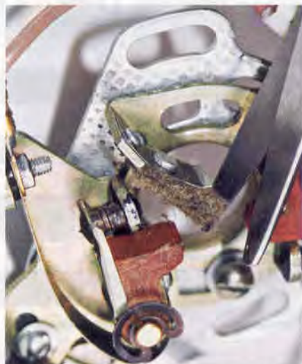
Волоски, торчащие из фильца, при работе мотора могут нарушить проводимость контактов. Перед установкой прерывателя остригите «бороду». Если фильц изначально сухой, смажьте его капелькой моторного масла.
