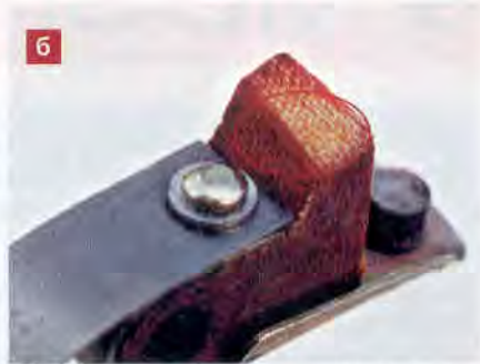
У текстолитовых упоров обязательно проверьте нажимную площадку: а – ровно обработанная деталь обеспечит стабильность зазора; б – брак (перекос), допущенный при обработке, приведет к быстрому износу площадки, зазор уменьшится и двигатель будет работать нестабильно.
