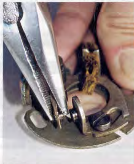
Подобный способ «выпрямления» контактов приводит к потере жесткости конструкции.
