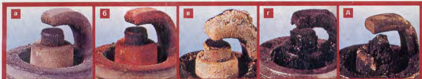
Варианты состояния изоляторов свечи зажигания: а – изолятор свечи исправного двигателя – приступайте к консервации; б, в – в топливе переизбыток примесей – смените бензин и добавьте в него «промывку»; г, д – с мотором «нелады» – до введения техники в «анабиоз» обратитесь к механику.
