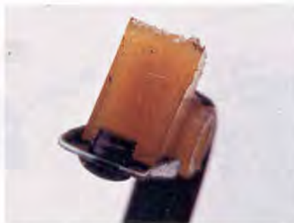
Характерный брак: заусенцы на капроновых нажимных площадках подвижных контактов.
