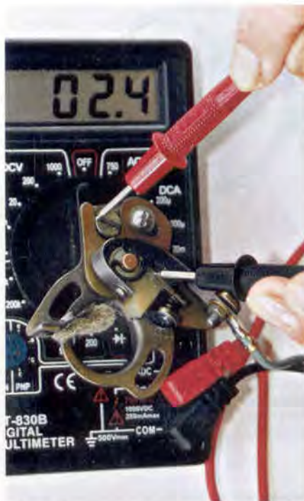
Контакты, показавшие сопротивление более 0,5 Ом, явно окислены. Выбирайте другой экземпляр детали.
