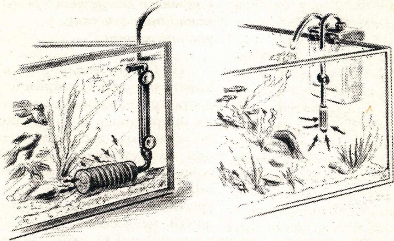
*Пузырьковый патронный фильтр (слева) и висячий на аквариуме внешний фильтр (справа). Сливной патрубок следует располагать непосредственно под поверхностью воды*
