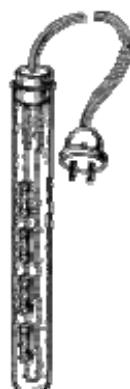
Аквариумный нагреватель из остеклованных сопротивлений.
