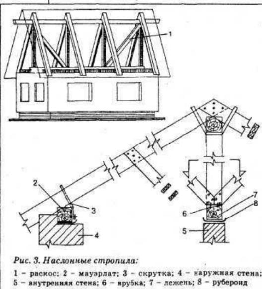
Стропильные ноги противоположных скатов крыши могут быть в одной плоскости и укладываются на коньковый прогон попеременно.
