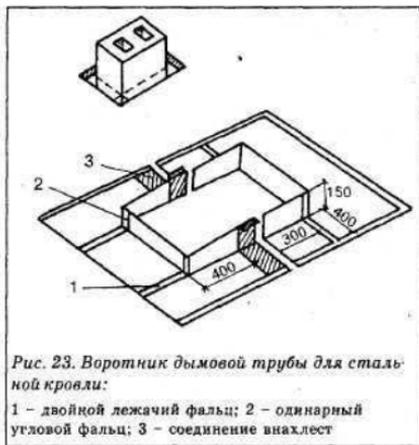
Рис. 23. Воротник дымовой трубы для стальной кровли:
