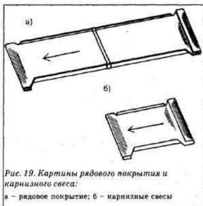
Рис. 19. Картины рядового покрытия и карнизного свеса:
