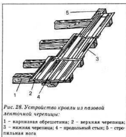
Рис. 28. Устройство крыши из пазовой ленточной черепицы:
