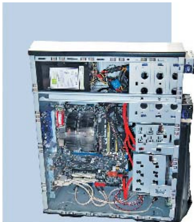
Устройство системного блока
