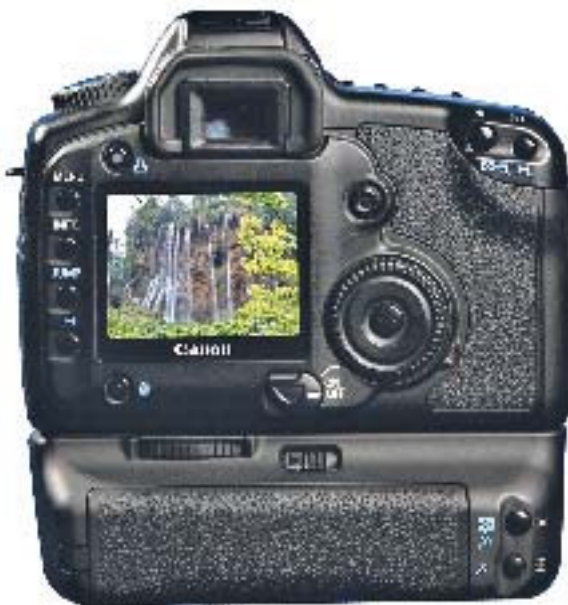
ЖК монитор полупрофессионального фотоаппарата (размер 2,5 дюйма)
