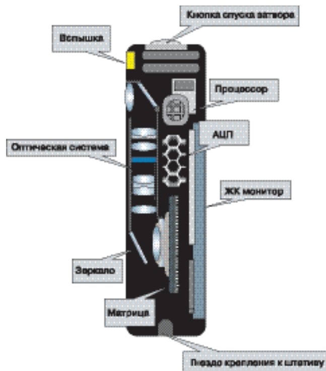
Устройство компактного аппарата с внутренней оптической системой
