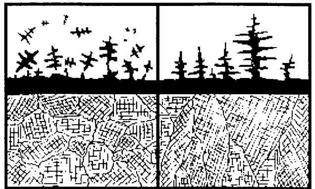
Рис. 3.39. Разноосные (слева) и столбчатые (справа) дендриты
