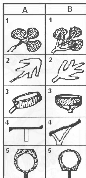
Рис. 2.16. Правильное (В) и неправильное (А) соединение литников
