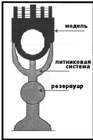
Рис. 3.41. Литниковая система с резервуаром
