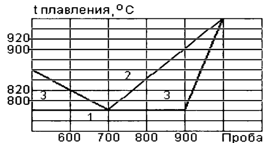
Рис. 1.4. Изменение температуры плавления сплавов серебра в зависимости от пробы
