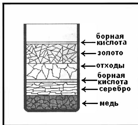
Рис. 3.32. Схема загрузки тигля
