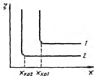
Рис. 1.42. Зависимость коэффициента потерь от числа кавитации
