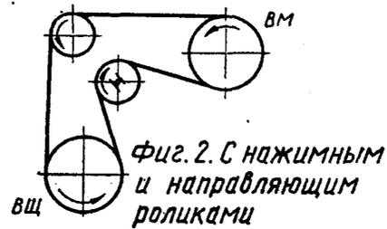
Фиг. 2. С нажимным и направляющим роликами
