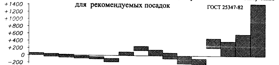
Табл. 17.3.5. Предельные отклонения и поля допусков ОТВЕРСТИЙ, мкм ГОСТ 25347-82 для рекомендуемых посадок
