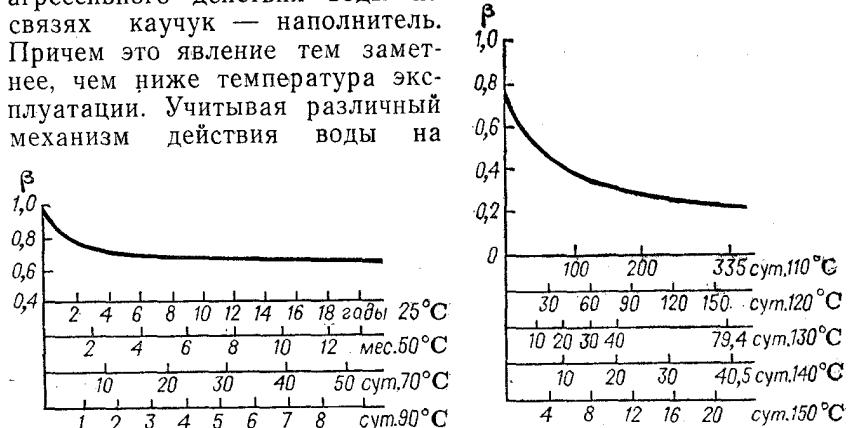
Рис. 65. Совмещенная кривая для прогнозирования релаксации напряжения в уплотнителях из резины на основе СКН-26 в воде.
