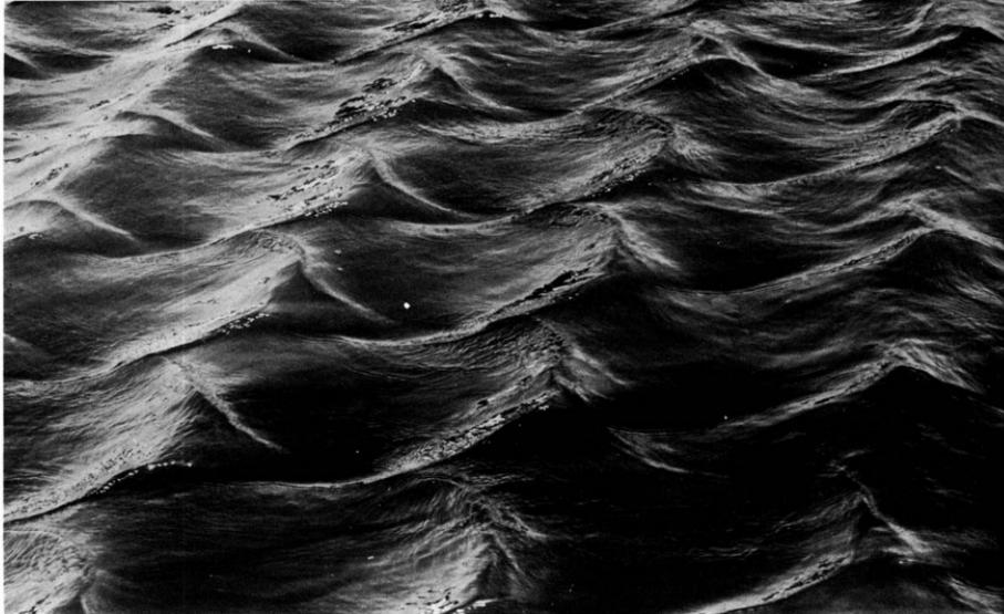
**194. Волны, разрушающиеся опрокидыванием.** Эта регулярная трехмерная структура, напоминающая структуру волн в открытом море, развилась за счет нелинейной неустойчивости из однородного
