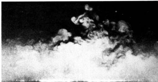
163. Косые поперечные сечения турбулентного пограничного слоя. Течение рассматривается спереди и визуализируется дымом, освещаемым световым ножом, который имеет наклон  $45^\circ$  вниз по потоку от стенки (левые снимки) и  $45^\circ$  вверх по потоку
