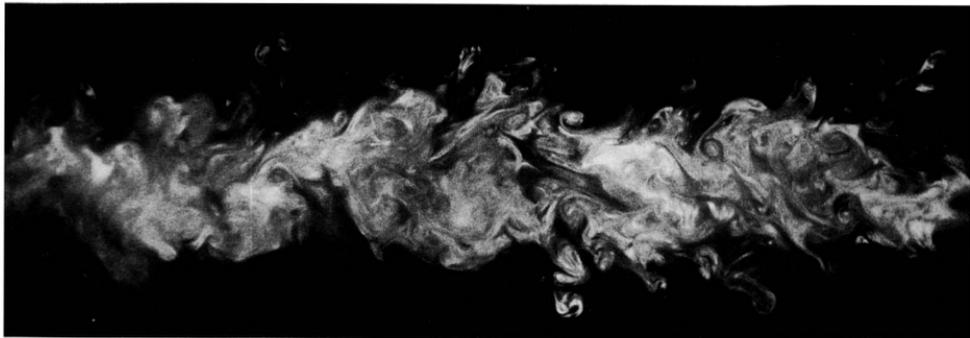
**174. Турбулентный след за цилиндром.** Лазерный световой нож прорезает след за круговым цилиндром при числе Рейнольдса 1770. Масляный туман демонстрирует мгновенную структуру течения, ох-
