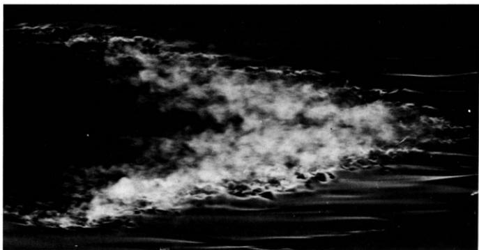
**111. Турбулентное пятно при различных числах Рейнольдса.** По мере возрастания числа Рейнольдса контур пятна становится более четким, а угол
