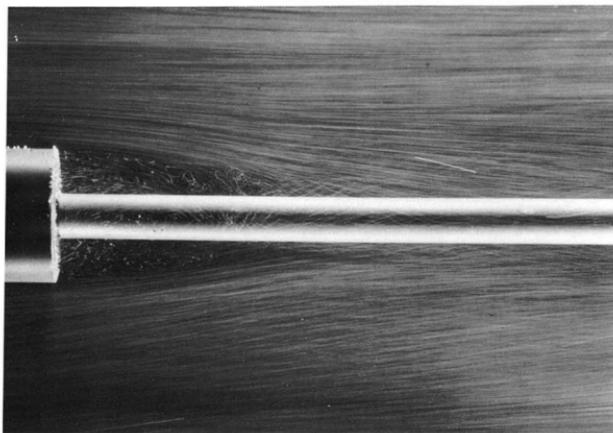
70. Осесимметричный поток, сходящий со ступеньки. При числе Рейнольдса, рассчитанном по длине тела и равном 10 000, пограничный слой в области отрыва ламинарен. Визуализация течения осуществляется с помощью воздушных пузырьков, освещаемых в воде. За ступенькой течение остается установившимся и ламинарным, превращаясь в неустановившееся и турбулентное далее вниз по потоку. Фото ONERA. [Werlé, 1974]
