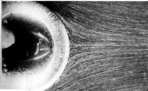
27. Течение за шаром при  $Re = 17,9$ . При увеличении скорости весьма трудно уловить момент начала отрыва в задней точке. Здесь поток должен быть еще присоединенным, так как вся эта серия экспериментов показала, что отрыв за изолированным шаром наступает примерно при  $Re = 24$ . [Taneda, 1956b]
