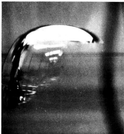
**185. Пузырь со сферической головкой и «вобкам».** Пузыри, содержащие 50–100 см<sup>3</sup> воздуха, поднимаются в минеральном масле. При скоростях, больших примерно 40 см/с, и вязкости, превы-
