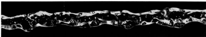
**181. Водяная струя в коаксиальном потоке воздуха.** На течение в начальном участке струи поток окружающего воздуха не влияет; однако, как показано на снимке, на расстоянии 238 диаметров вниз по потоку винтовая неустойчивость струи оказывает-
