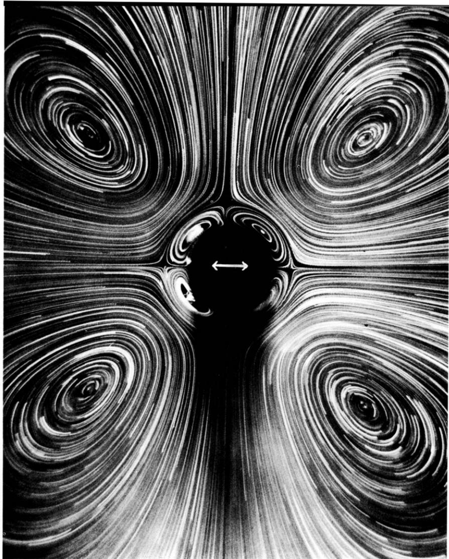
31. Вторичные течения, индуцируемые колеблющимся цилиндром. Длинный круговой цилиндр колеблется в смеси воды с глицерином по направлению нормали к своей оси под действием громкоговорителя. Взвешенные в жидкости стеклянные шарики подсвечиваются в поперечной плоскости стробоскопом. Амплитуда колебаний составляет
