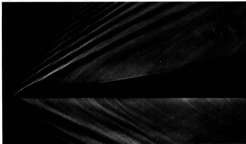
**229.** Гидравлическая аналогия обтекания клина сверхзвуковым потоком. Однородный слой воды глубиной 5 мм течет со сверхкритической скоростью по горизонтальной плоскости и отклоняется заостренным клином с углом при вершине  $10^\circ$  и с нижней гранью, параллельной потоку. Гравита-
