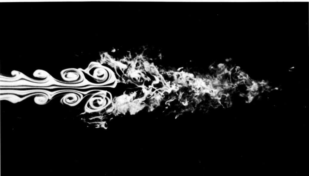
**102. Неустойчивость осесимметричной струи.** Ламинарный поток воздуха вытекает из круглой трубы при числе Рейнольдса 10 000 и визуализируется с помощью дымовой проволочки. Во внешней области струи развиваются осесимметричные
