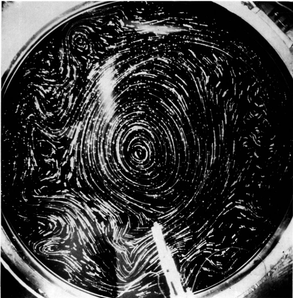
**136. Конвекция во вращающемся цилиндре.** Структура течения во вращающейся «сковороде-кастрюле», нагретой по внешней границе и охлажденной в центре, удивительно похожа в своих основных чертах на структуру земной атмосферы в средних широтах. Здесь слой воды глубиной 4 см в цилиндре диаметром 19,5 см вращается против часовой стрелки, совершая 30 об/с, и нагревается при но-
