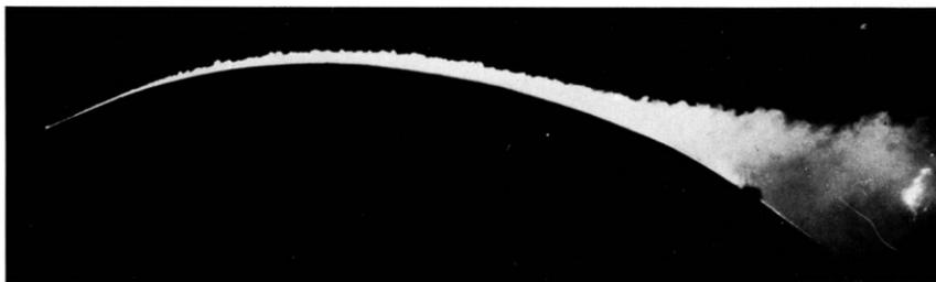
156. Сравнение ламинарного и турбулентного пограничных слоев. Ламинарный пограничный слой, показанный на верхнем снимке, отрывается на вершине выпуклой поверхности (ср. с фото 38), тогда как турбулентный слой, показанный на нижнем снимке верхней пары, остается присоединенным;
