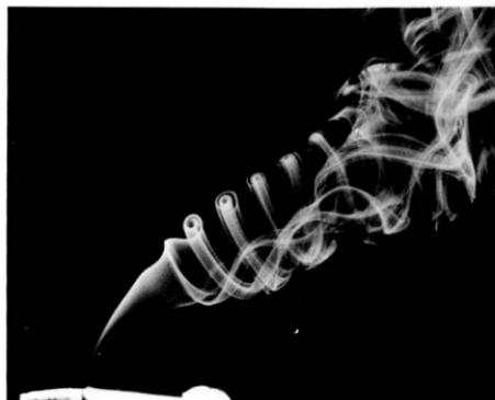
дыма становится неустойчивым и создает два концевых вихря, соединенных между собой сеткой вихревых петель, напоминающей лесенку. [Perry, Lim, 1978]
