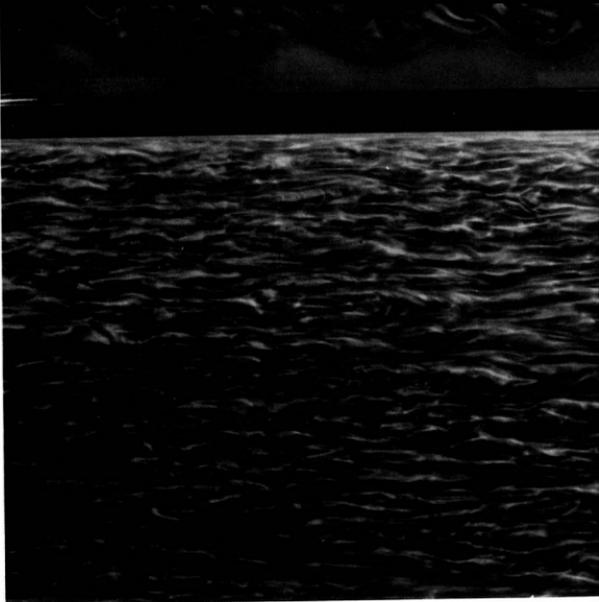
**160. Деталь подслоя.** Снятый крупным планом дым в турбулентном пограничном слое на полу аэродинамической трубы обнаруживает «карманы» и полосы в вязком подслое. [Falco, 1980]
