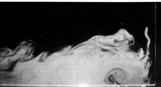
165. Турбулентный пограничный слой, набегающий на цилиндр. Когда турбулентный пограничный слой обтекает круговой цилиндр, установленный нормально к стенке, вихри во внешней области подвергаются быстрому искажению, а в области отрыва образуется перемежающаяся обратная струя. На фото 92 показано аналогичное течение с ламинарным пограничным слоем. Фото R. E. Falco
