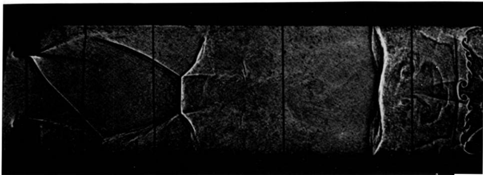
**240. Дифракция ударной волны внутри прямоугольного ящика.** Ударная волна в азоте дифрагирует при прохождении через окно на одном конце прямоугольного ящика и отражается от другого его конца. На тневой фотографии видна замечательная картина ударных волн, линий скольжения и вихрей, причем картина вполне определенная и воспроизводимая. Три следа, видные справа и напоминающие витые веревки, представляют собой
