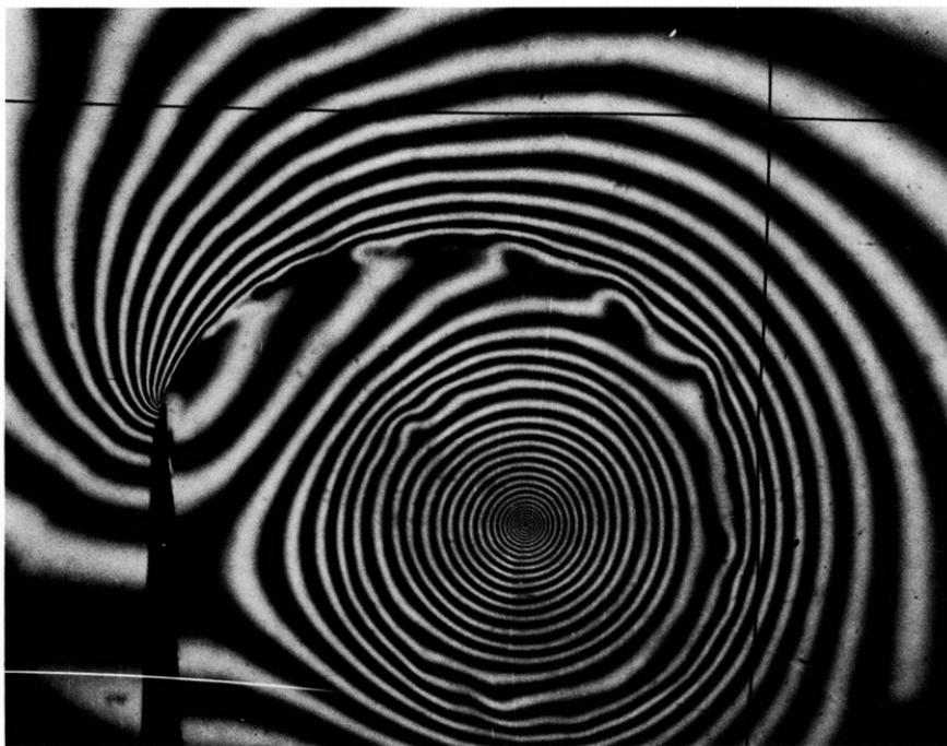
**83. Распределение плотности в вихре от клина.** Совершенно иная картина того же явления, что и на фото 82, получается на приводимой здесь интерферограмме в полосах бесконечной ширины, показывающей линии постоянной плотности. Порази-
