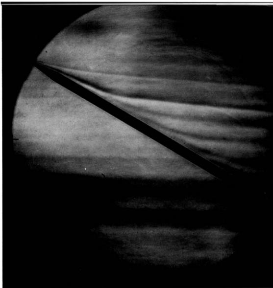
**89. Вихри, сходящие с тела в сверхзвуковом потоке.** Здесь угол атаки равен  $35^\circ$ , а число Маха свободного потока равно 1,6, так что компонента числа Маха, нормальная к оси тела, равна 0,92. Поэтому в подветренной области головная ударная волна вниз по потоку отодвигается все дальше от цилиндра. Слабая ударная волна отходит от линии сопряжения конуса с цилиндром. Другие ударные волны появляются между задней кромкой тела и рядом поочередно сходящих с нее вихрей. Фото К. D. Thomson
