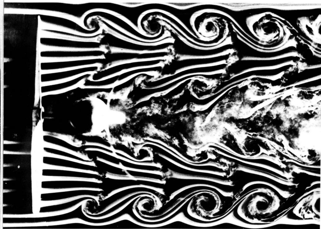
75. Вихри за вращающимся винтом. Впечатляющая картина винтовых концевых и корневых вихрей визуализирована дымом в аэродинамической трубе Университета Нотр-Дам. Поток движется со ско-
