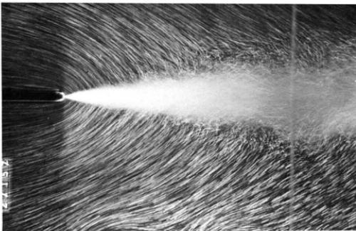
**170. Захват жидкости осесимметричной турбулентной струей.** Турбулентная струя подкрашенной воды вытекает из трубы диаметром 9 мм при скорости 200 см/с. В согласии с теорией пограничного слоя линии тока, маркируемые воздушными пузырьками в воде вне струи, представляют собой параболы вращения или параболы в плоском случае, показанном на предыдущем снимке. Фото ONERA. [Werlé, 1974]
