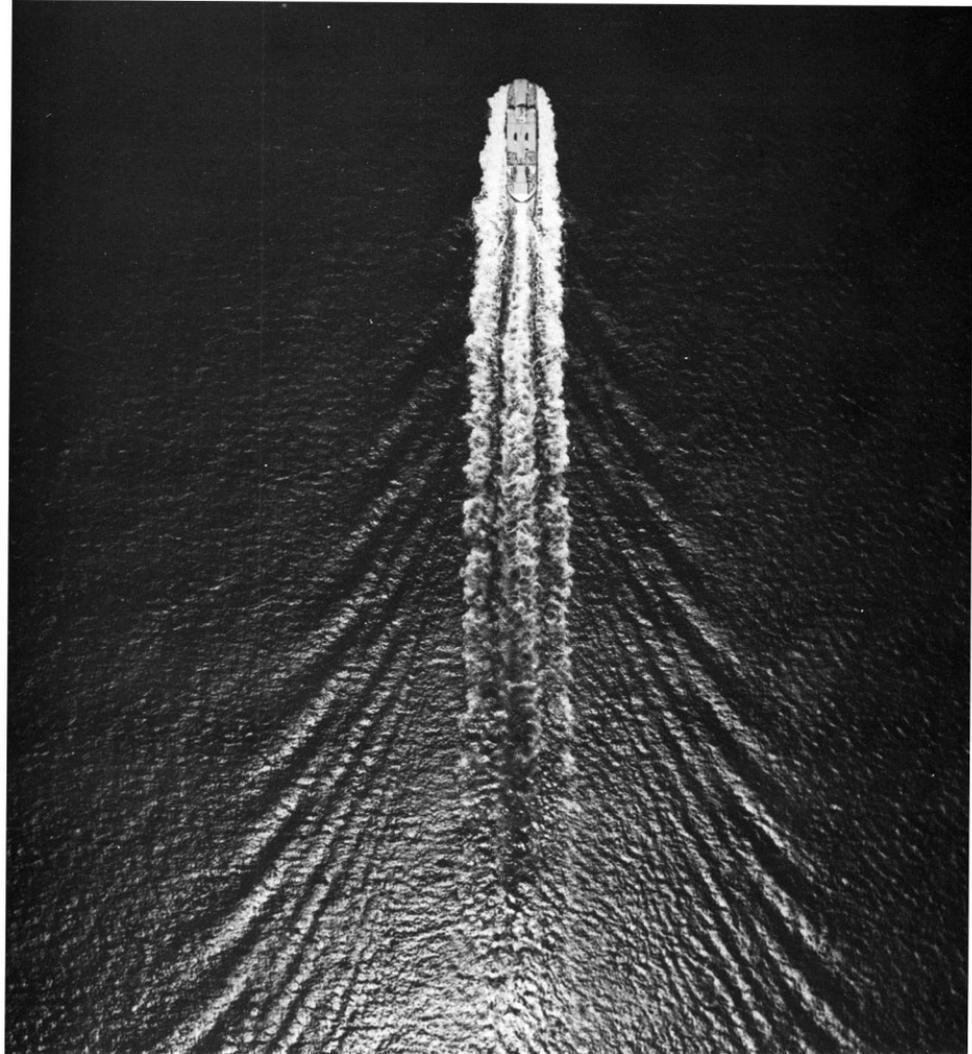
**201. Конфигурация волн, создаваемая кораблем.** Снимок, сделанный с воздуха непосредственно над кораблем, показывает не только носовую волну и турбулентный след, но и асимптотическую структуру, теоретически установленную в 1887 г. Кельвином. В согласии с теорией волновая область
