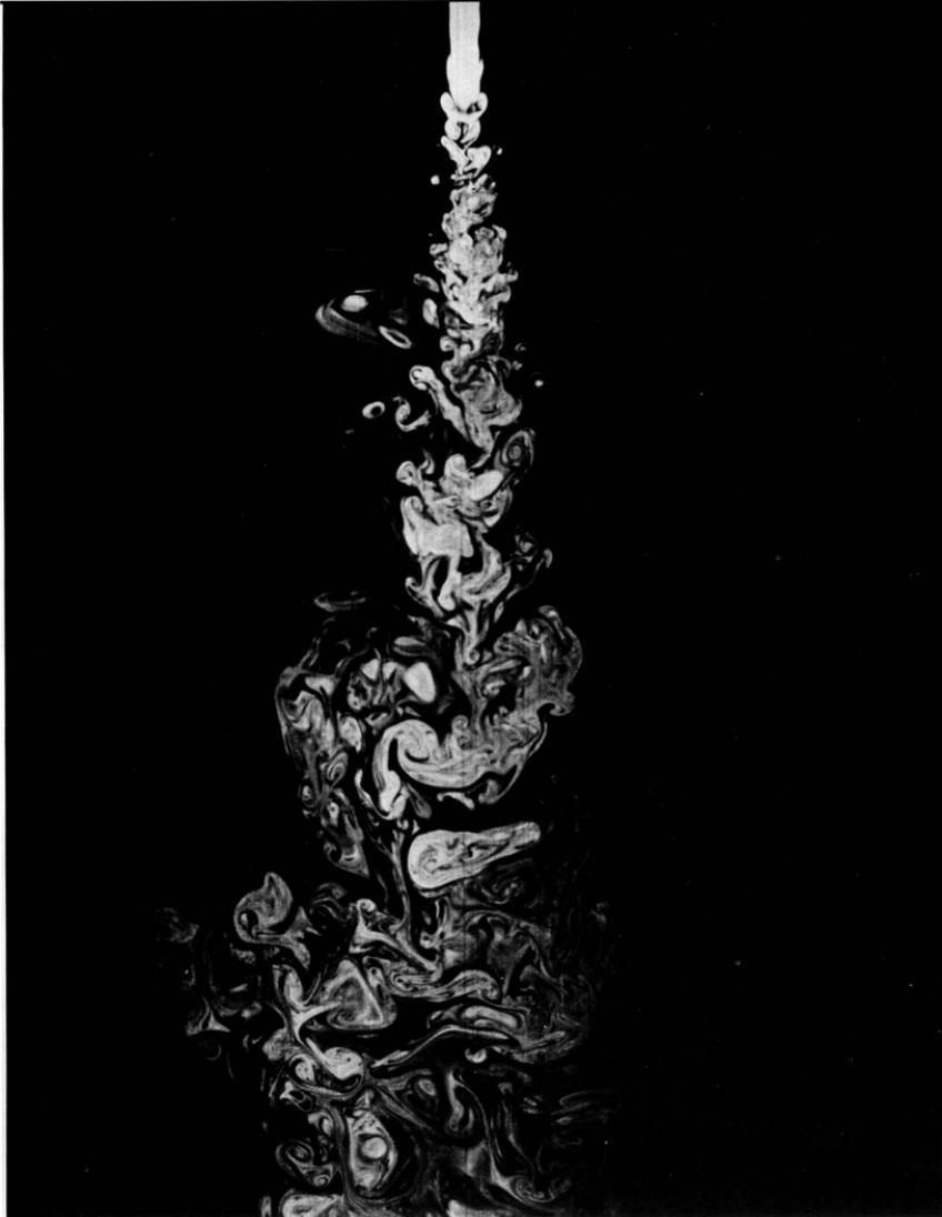
166. Турбулентная струя воды. Индуцированная лазером флуоресценция показывает картину внедрения жидкой струи в окружающую жидкость в плоскости симметрии осесимметричной водяной струи, направляемой сверху вниз в воду. Число
