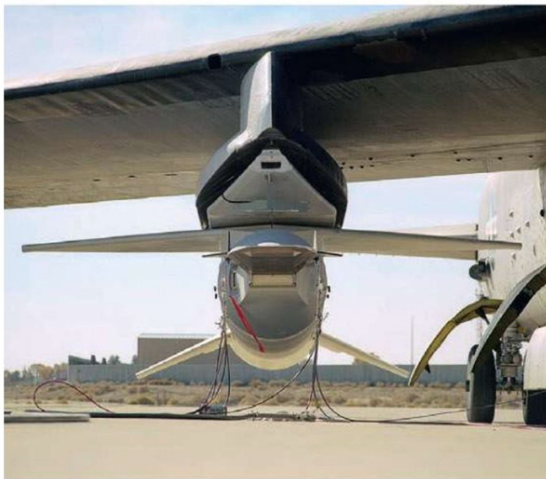
Экспериментальный беспилотный аппарат NASA X-43 установил рекорд скорости для летательных аппаратов с воздушно-реактивным двигателем, разогнавшись до 10 617 км/ч, или 9,68М. Рекордный полет третьего прототипа X-43 состоялся 16 ноября 2004 года. Разгонная ракета «Пегас», запущенная с борта бомбардировщика В-52, разогнала аппарат и отделилась на высоте 29 000 м. За 10 секунд работы ГПВРД X-43 преодолел 24 км, поднявшись на высоту около 34 000 м. Затем одноразовый аппарат был затоплен неподалеку от калифорнийского побережья.
