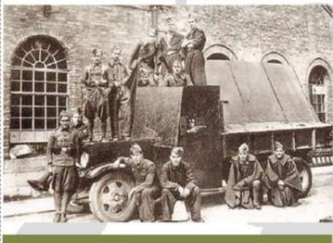
■ Безымянный тизнаос на базе грузовика, обшитого котельным железом (хорошо видны места грубого соединения листов), построенный на оружейном заводе Овьедо в 1934 году (времена восстания в Астурии). Крыша «домиком» защищала от гранат, которые скатывались с машины и взрывались позади, когда броневик уже проезжал.
