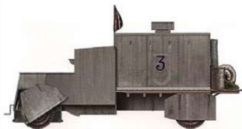
Тизнаос Pamplona №3. В Памплоне строились простые и примитивные броневедомобили – обычные грузовые автомобили просто обшивались котельным железом или листами заводской брони.
