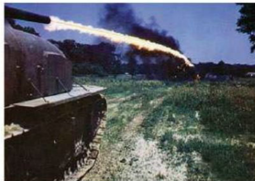
■ Огнеметные танки американские военные остроумно прозвали Zippo в честь производителя зажигалок. На фото – огнеметная модификация танка Sherman – M4A3R3 Zippo (использовался при Иводзиме в 1945 году).
