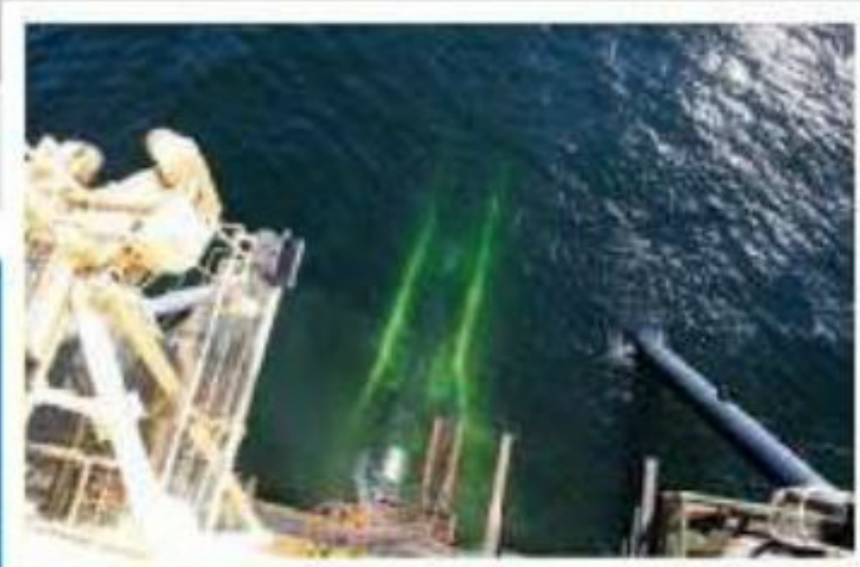
КОРМА ТРУБОУКЛАДЧНОГО СУДНА СО СТИНГЕРОМ – специальным желобом, увеличивающим радиус сгиба укладываемой нитки. Благодаря стингеру буква S обретает более плавные очертания.
