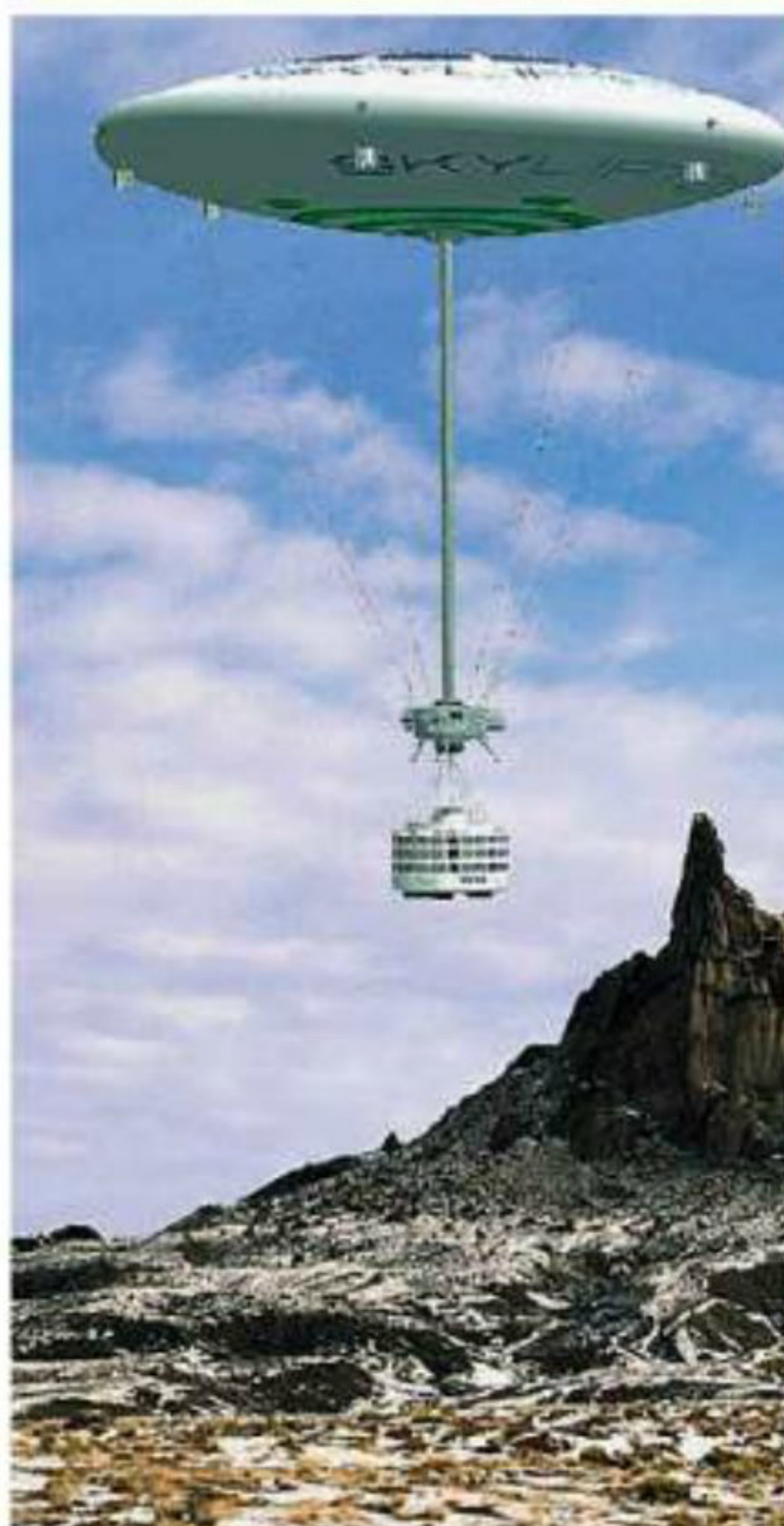
■ СМЕННАЯ ГОНДОЛА SKYPALACE может быть переносным домом – например, SL150 может доставить ее прямо на курорт, где она послужит корпусом санатория. На рисунке пассажирская часть пристегнута тросами к пилотской гондоле, в иных конфигурациях она крепится непосредственно к связывающей ее с оболочкой трубе. По сути SL150 – это конструктор.
