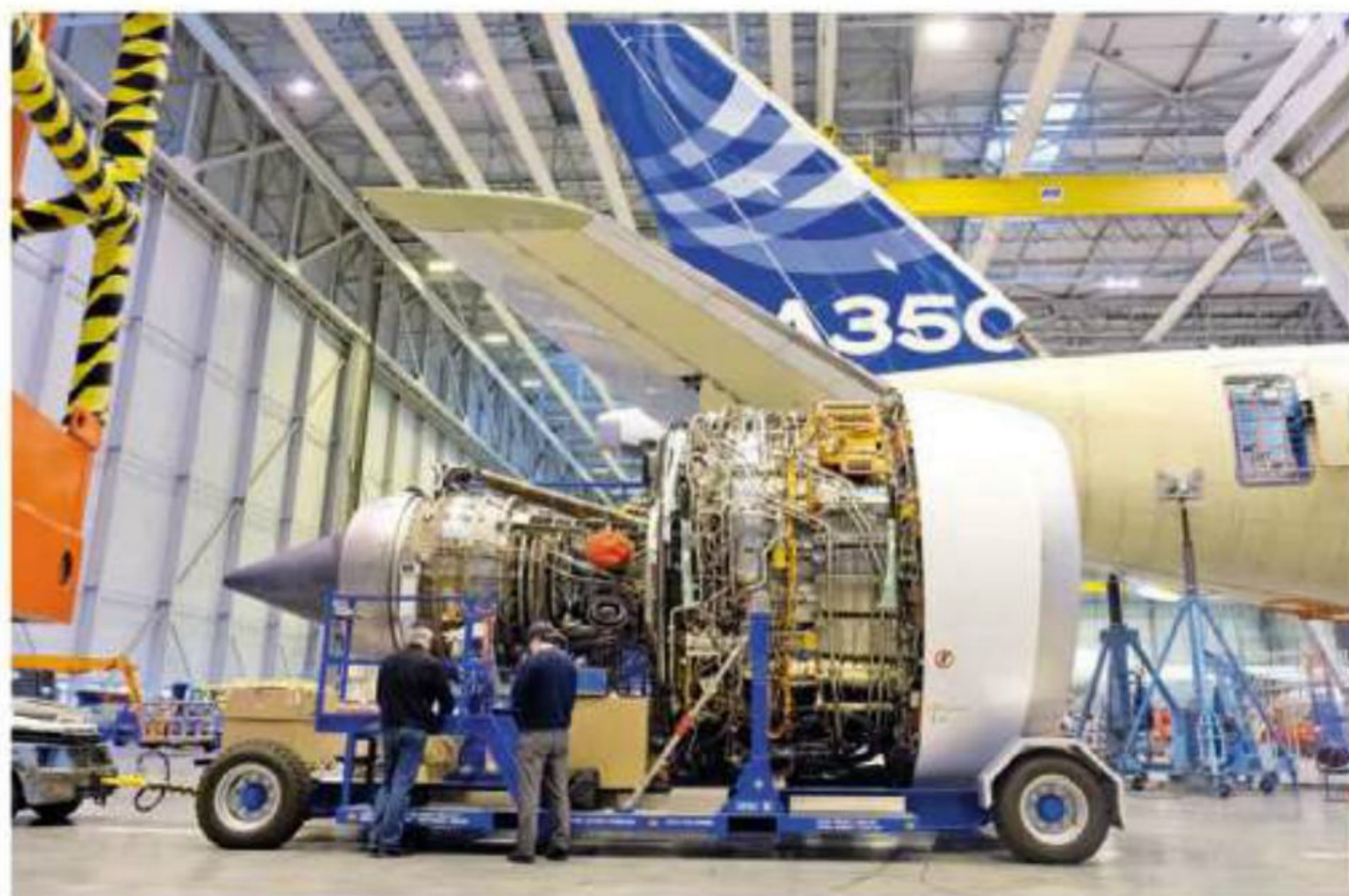
МОЩНАЯ ТЯГА Двигатель Rolls Royce Trent XWB развивает максимальную тягу в 430 кН и оснащен трехметровым в диаметре вентилятором. Мотор разработан специально под A350 XWB и предварительно испытывался на летающей лаборатории A340-300.
