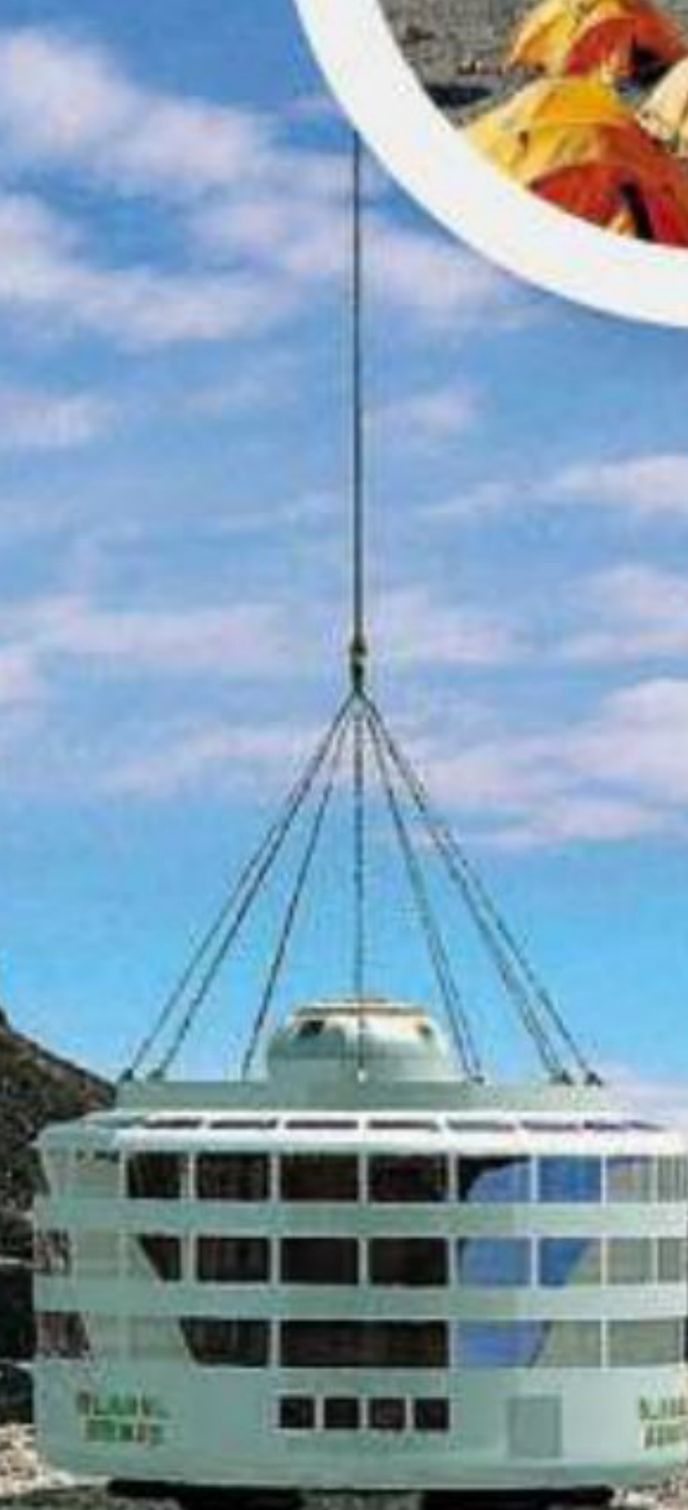
■ СМЕННАЯ ГОНДОЛА SKYPALACE может быть переносным домом – например, SL150 может доставить ее прямо на курорт, где она послужит корпусом санатория. На рисунке пассажирская часть пристегнута тросами к пилотской гондоле, в иных конфигурациях она крепится непосредственно к связывающей ее с оболочкой трубе. По сути SL150 – это конструктор.
