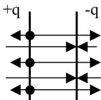
1) Плоский конденсатор (заполнен диэлектриком с диэлектрической проницаемостью  $\epsilon$ ). На рисунке изображены силовые линии поля каждой пластины. Вне области между плоскостями поля вычитаются, а внутри электрические поля складываются, тогда
