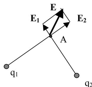
Если мы знаем величину и направление вектора электрического поля в любой точке пространства, то можно построить картину, называемую линиями вектора напряженности или силовыми линиями электрического поля. Касательная к такой линии указывает направление силы, которая будет действовать на
