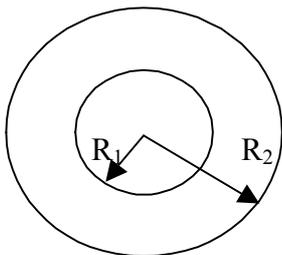
диэлектрической проницаемостью  $\epsilon$ ). Поместим на внутреннюю обкладку заряд  $q$ , а на внешнюю заряд  $-q$ . Найдём по теореме Гаусса поле во всем пространстве. Поле в области пространства  $r < R_1$  равно нулю, так как сферическая поверхность с центром в точке  $O$  такого радиуса никаких зарядов не охватывает, и, следовательно,  $\oint \vec{E} d\vec{S} = 0$ .
