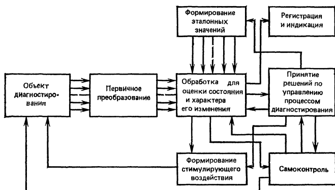
Рис. 58.7. Схема диагностики технических объектов
