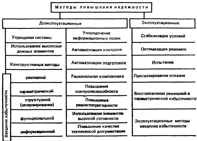
Рис. 58.8. Классификация методов повышения надежности
