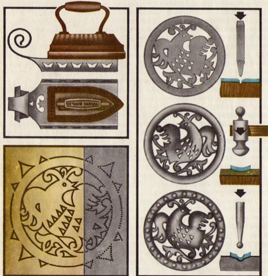
1 — подставка для утюга; 2—3 — последовательность выполнения просечного декора фонаря: переведение рисунка на металл; просекание металла по размеченным контурам; обработка просечного ажура выколоточным молотком или чеканом на свинцовой плите; нанесение чеканом полусферических углублений.
