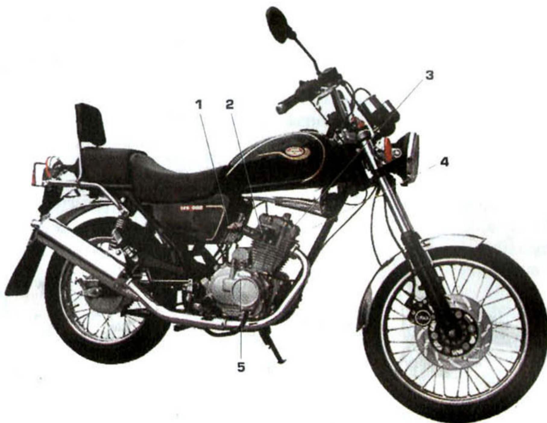
Рис. 2.31. Точки обслуживания механизмов и систем четырехтактного двигателя: 1 — очистка (замена) воздушного фильтра; 2 — очистка (замена) топливного фильтра, регулировка карбюратора; 3 — регулировка зазора в клапанах; 4 — регулировка натяжения цепи (ремня) привода ГРМ; 5 — замена масла в двигателе, замена масляного фильтра
