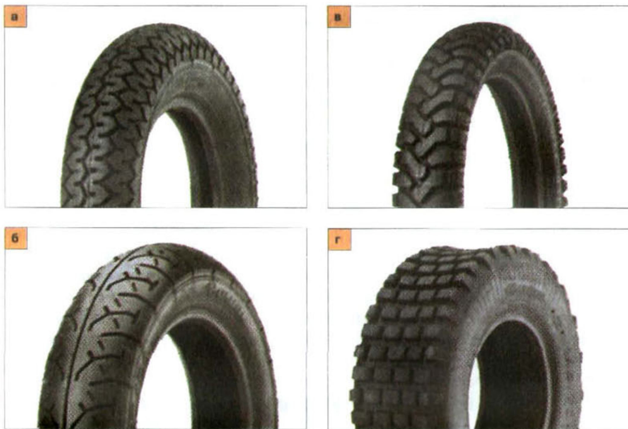
Рис. 5.25. Виды протектора шины для мотоциклов разных классов: а — классика и круизера; б — спортбайка; в — мотоцикла двойного назначения; г — ATV
