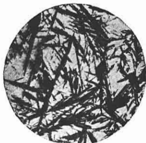
Фиг. 13. Микроструктура закаленной стали: темные мартенситные иглы на фоне аустенитных зерен. \times 500 .
