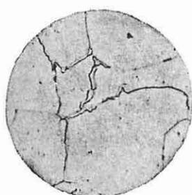
Фиг. 5. Микроструктура котельной стали марки 3Т; по границам зерен феррита имеются частицы цементита. \times 500 .
