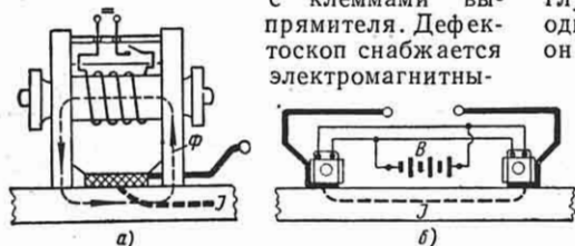
Фиг. 43. Электромагнитные контакты: а — схема устройства; б — схема намагничивания.
