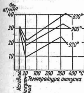
Фиг. 13. [2]. Влияние температуры закалки и отпуска на прочность и твердость чугуна.
