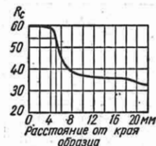
Фиг. 52. Твердость образца графитизированной стали по сечению.
