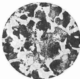
Фиг. 8. Микроструктура стали, содержащей 0,35% углерода, \times 300 .
