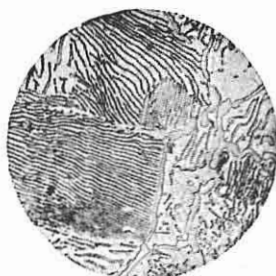
Фиг. 7. Микроструктура стали (0,8%С), обработанной на пластинчатый перлит. \times 500 .
