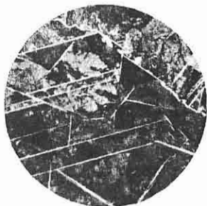
Фиг. 10. Микроструктура стали, содержащей 1,3% углерода. \times 300 .
