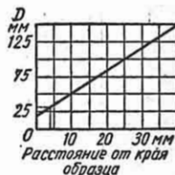
Фиг. 53. Значения критического диаметра образца графитизированной стали.
