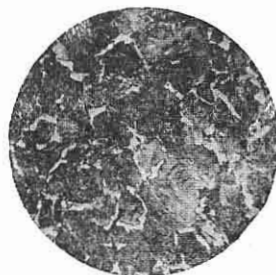
Фиг. 9. Микроструктура стали, содержащей 0,7% углерода. \times 300 .
