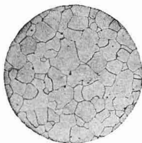
Фиг. 3. Микроструктура технически чистого железа, \times 150 .
