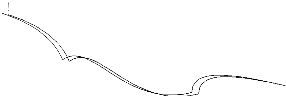
Рис. 28. Схема окончательного профилирования траектории по нескольким цепочкам
