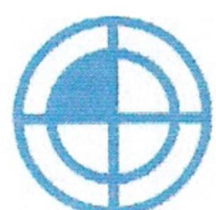
Нулевая точка станка М определяется изготовителем и не может быть изменена. При фрезеровании она находится в начале системы координат станка и при токарной обработке на опорной поверхности передней части шпинделя.
