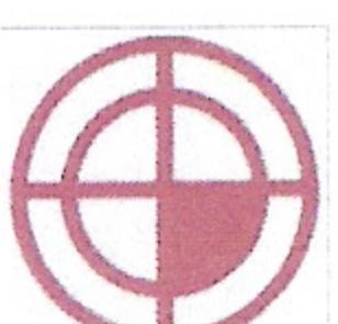
Нулевая точка заготовки W, называемая также нулевой точкой программы, является началом системы координат заготовки. Она может выбираться свободно и должна быть расположена при фрезеровании там, откуда на чертеже исходит большинство размеров.
