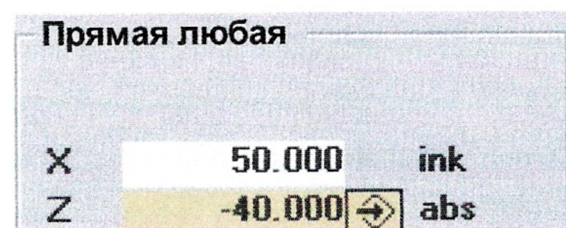
Для определения конечной точки прямой применяются две величины. Они могут выглядеть следующим образом: см. рис.
