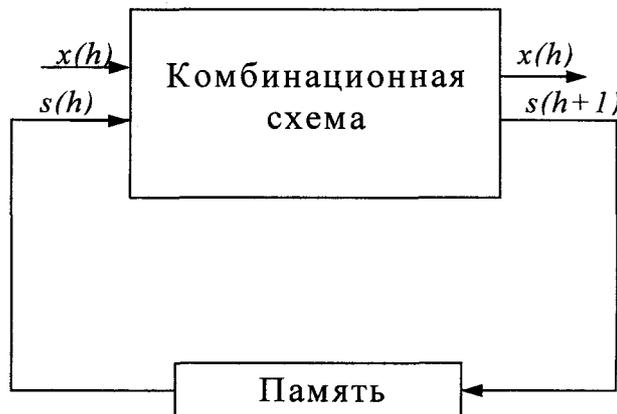
Рис.3.1. Структурная схема конечного автомата
