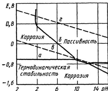
Рис. 9.2. Упрощенная диаграмма Пурбэ для системы Fe—H<sub>2</sub>O при температуре 298 К
