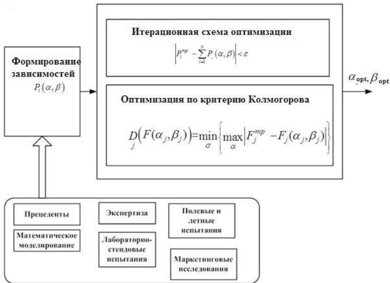
Рис. 79. Схема оптимизации характеристик  $i$ -го подсистемы
