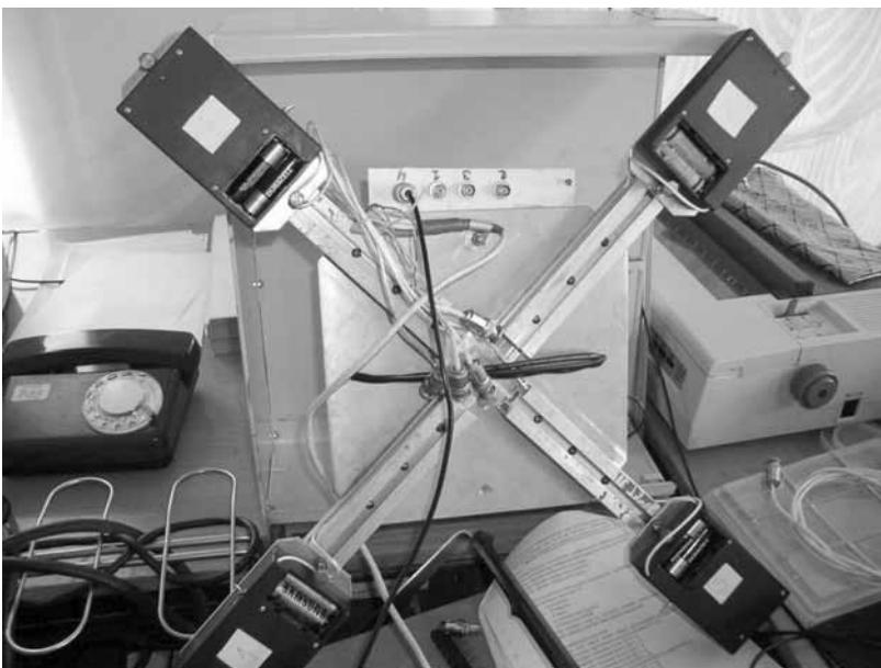
Рис. 115. Размещение 4-х датчиков АК СПС в 2-х взаимно перпендикулярных плоскостях
