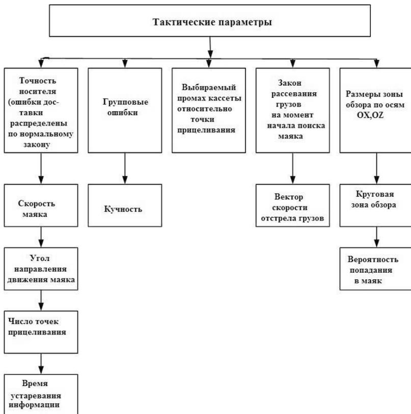
Рис. 86. Перечень тактических параметров для СПС
