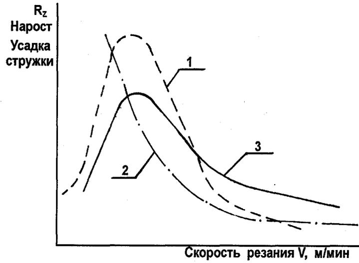
1 – нарост на резце; 2 – усадка стружки; 3 – высота шероховатости
