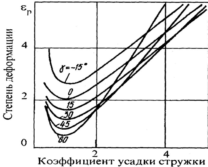
Рисунок 3.11. Зависимость степени деформации  $\varepsilon$  от коэффициента усадки стружки  $K_L$  [77]
