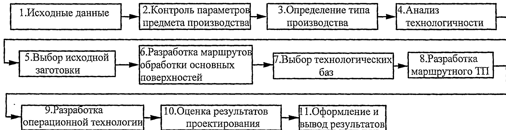
Рис.1.10 Этапы неавтоматизированной разработки единичных ТП изготовления деталей машин
