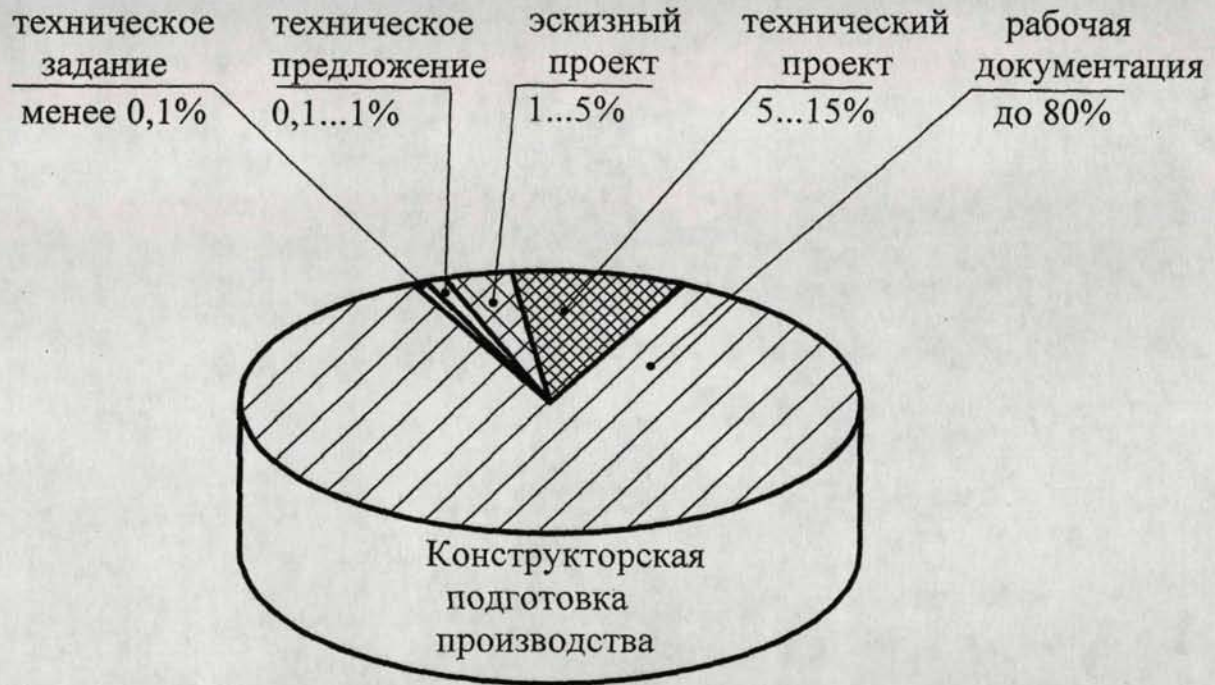
Рис.1.3 Ориентировочное соотношение объемов информации, создаваемой и обрабатываемой на стадиях КПП
