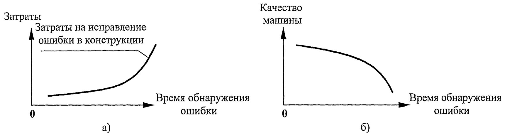
Рис.1.9 Влияние времени обнаружения ошибки на затраты на ее исправление (а) и качество машины (б)
