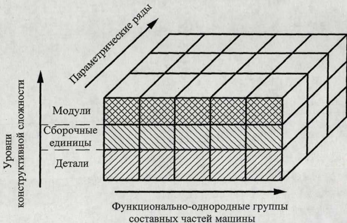
Рис.1.4 Модель структуры функционально-модульной конструкции машины
